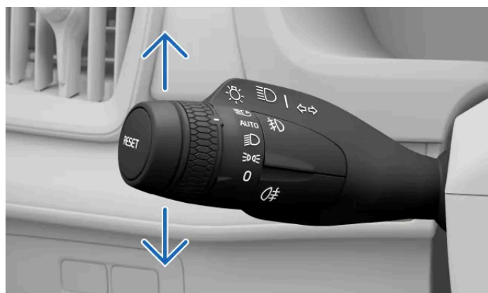
Blinkers på den vänstra rattspaken
