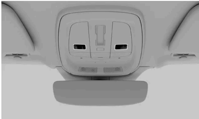
De främre läslamporna på takkonsolen
