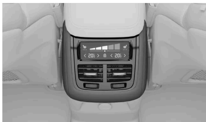
Klimatreglage på tunnelkonsolen
