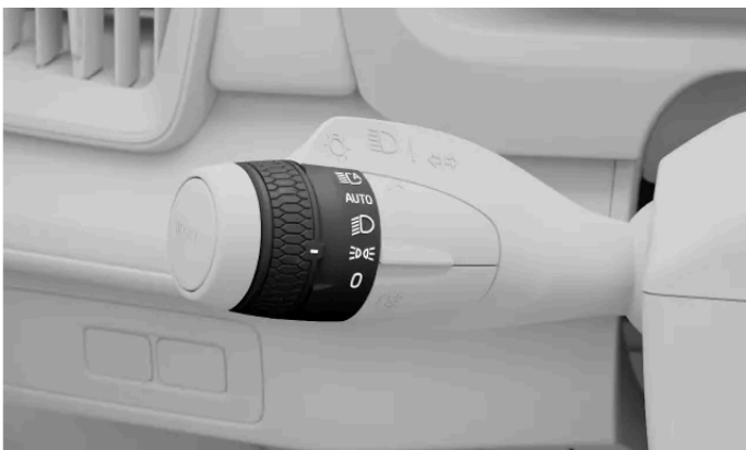
Positionslyssymbolen på vridningen på vänster rattspak
