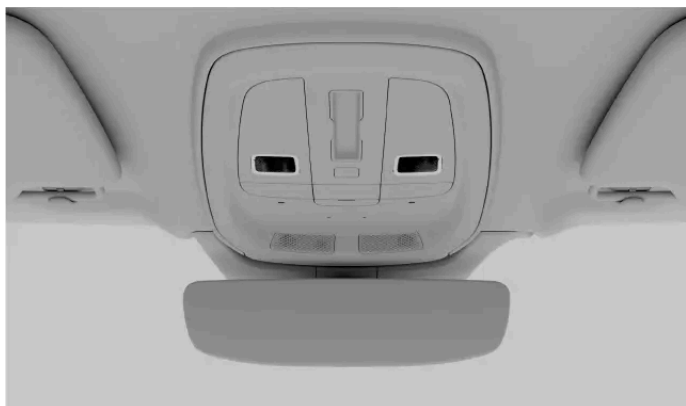
De främre läslamporna på takkonsolen
