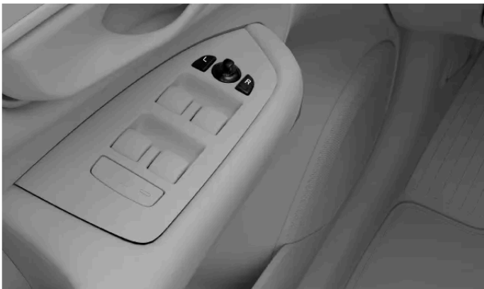
Reglage för justering av sidospeglarna
