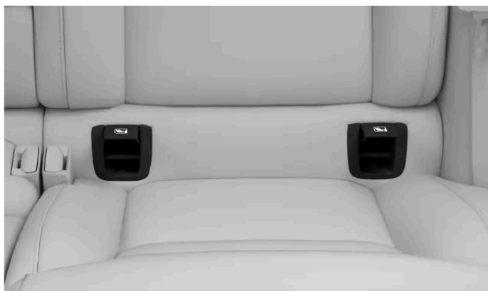
Placeringar av ISOFIX-förankringspunkter för de yttre baksätena.
