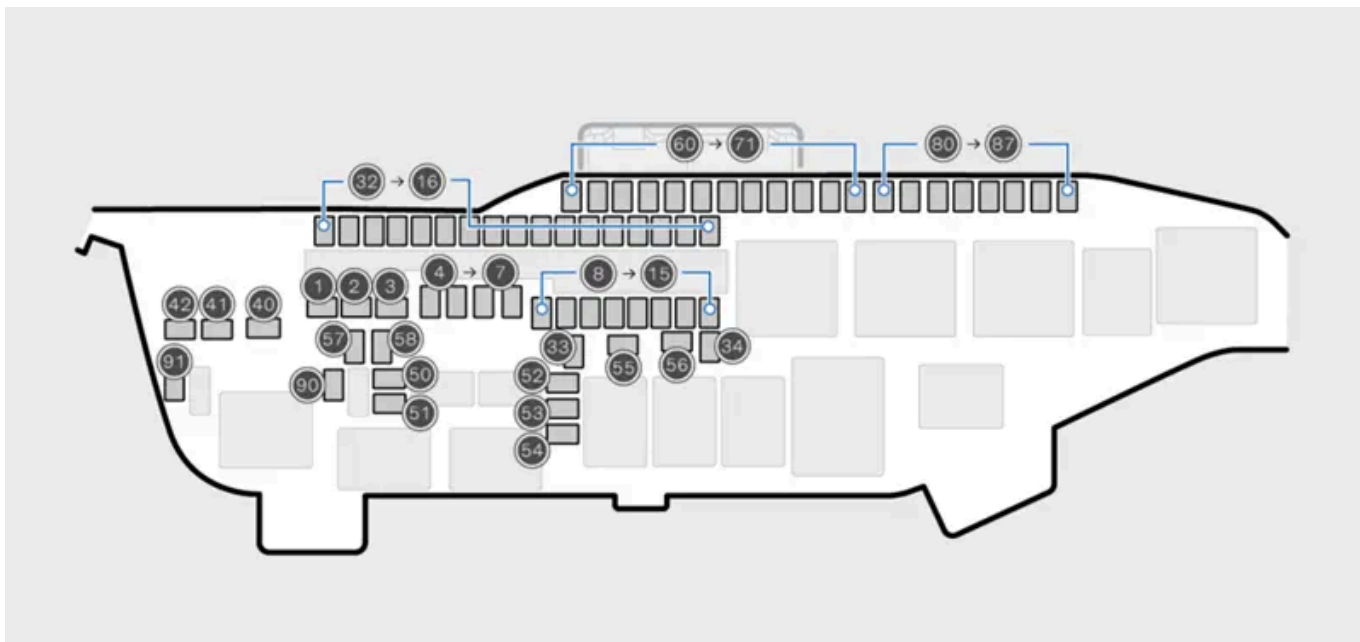
Diagram som visar säkringarnas placering
