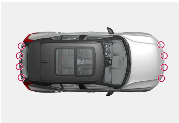
Parkeringsensorernas placering runt bilen
