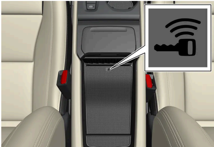
Backup-läsarens placering i tunnelkonsolen.
