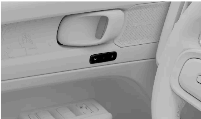
Placering av knapparna för förinställningar av sätesjustering
