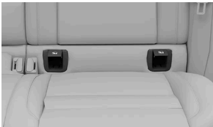
Placeringar av ISOFIX-förankringspunkter för de yttre baksätena.
