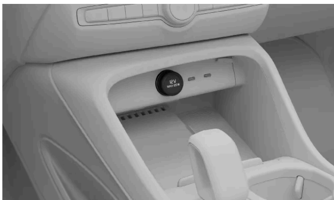
12 V-eluttaget i tunnelkonsolen
