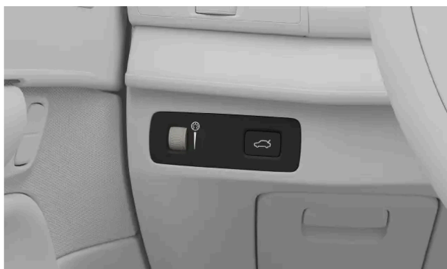
Tumhjul för justering av innerbelysningen
