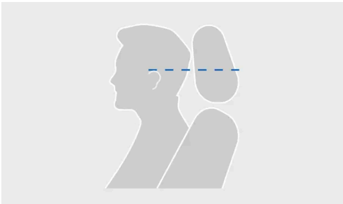
Korrekt nivå på nackstödet
