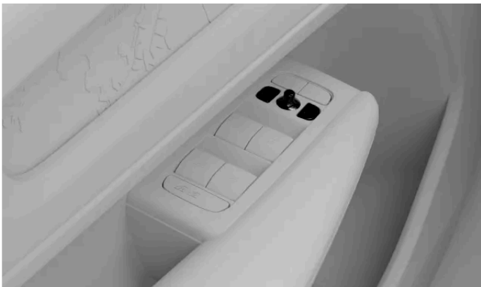
Reglage för justering av sidospeglarna
