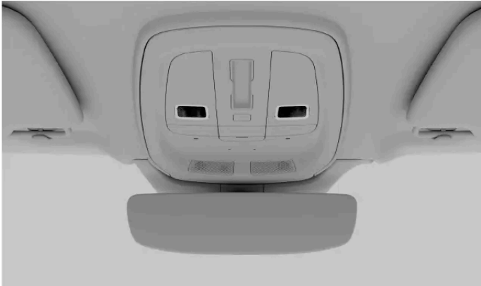
De främre läslamporna på takkonsolen
