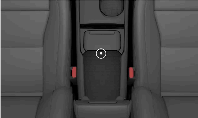
Reservläsarens placering i förvaringsfacket i tunnelkonsolen
