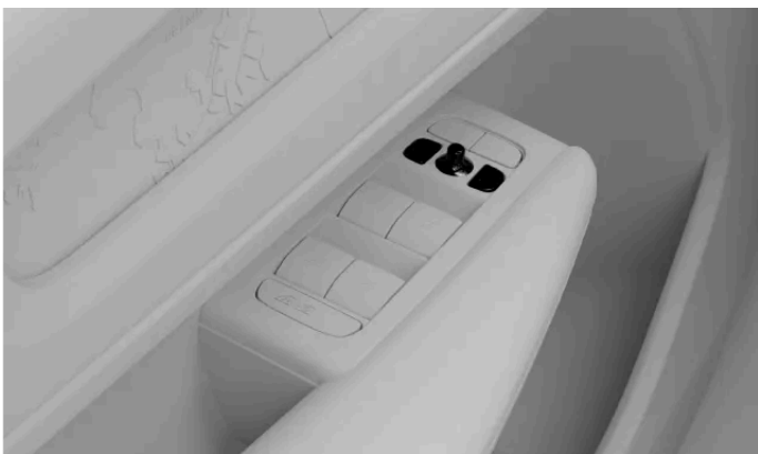
Reglage för justering av sidospeglarna
