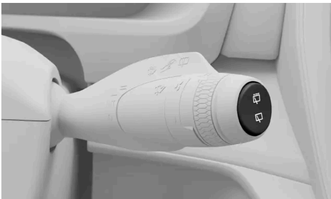
Bakrutetorkarens reglage sitter på höger rattspak.
