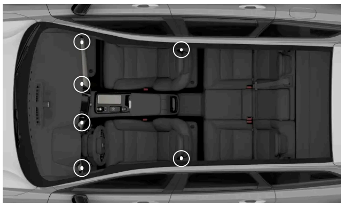
De reglerbara ventilationsmunstyckenas placering
