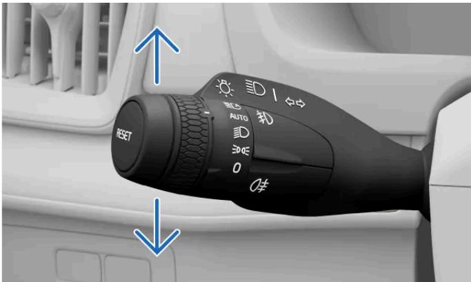
Blinkers på den vänstra rattspaken
