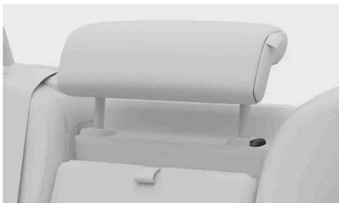
Låsknapp på nackstödet
