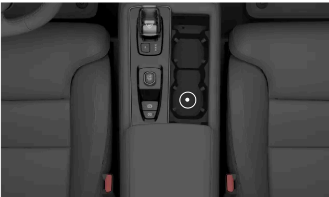
Placering av backup-läsaren i mugghållaren i tunnelkonsolen
