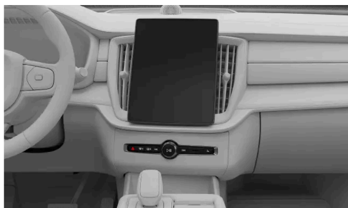
Centerdisplay och avfrostningsknappar på knappen nedanför centerdisplayen
