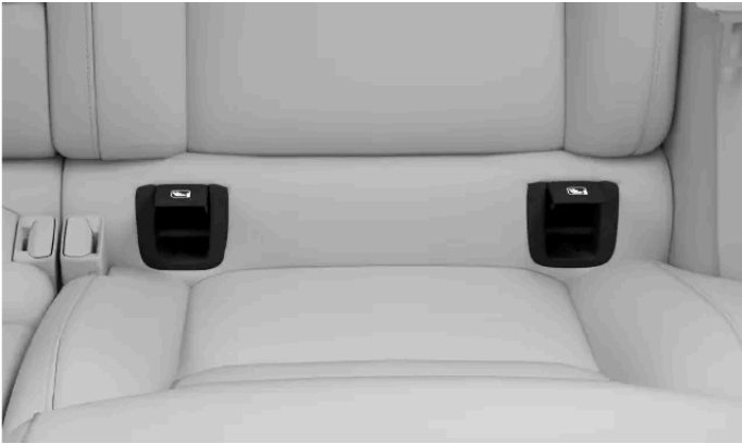
Placeringar av ISOFIX-förankringspunkter för de yttre baksätena.
