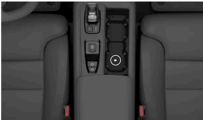
Reservläsarens placering i mugghållaren i tunnelkonsolen
