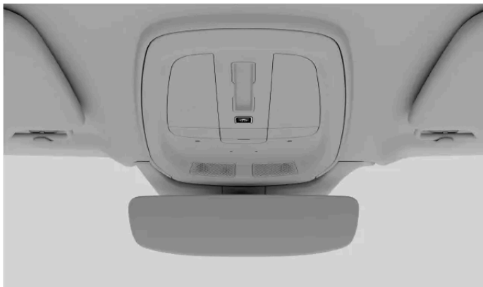
Automatisk belysning av-knapp i takkonsolen
