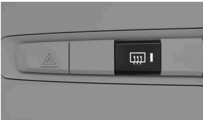
Knapp för avfrostning av bakrutan på knapppanelen nedanför centerdisplayen.
