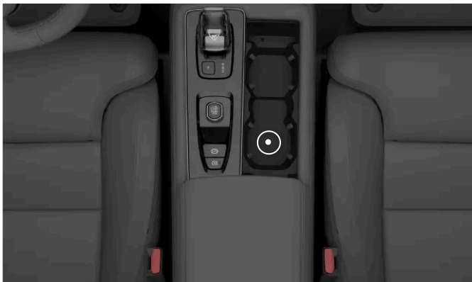
Placering av backup-läsaren i mugghållaren i tunnelkonsolen
