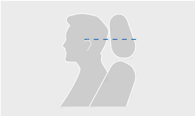
Korrekt nivå på nackstödet
