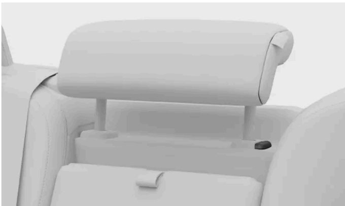
Låsknapp på nackstödet
