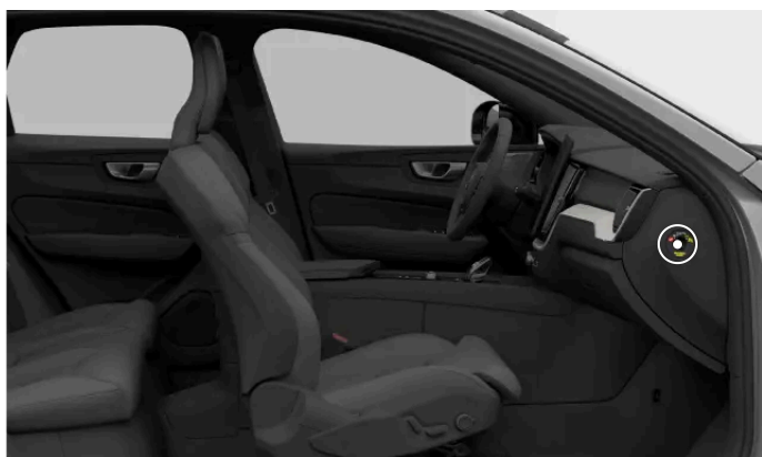
Placering av passagerarkrockkuddens omkopplare
