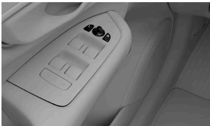
Reglage för justering av sidospeglarna
