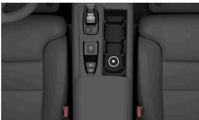
Placering av backup-läsaren i mugghållaren i tunnelkonsolen
