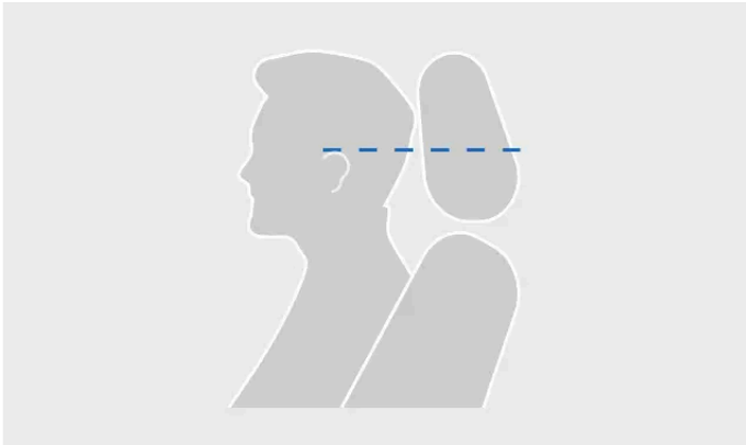
Korrekt nivå på nackstödet
