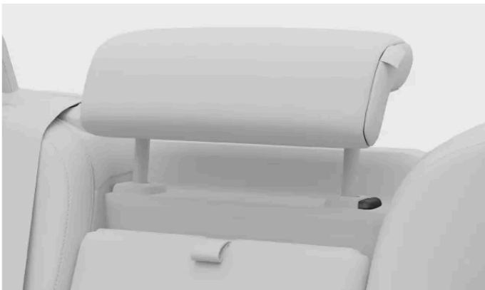
Låsknapp på nackstödet
