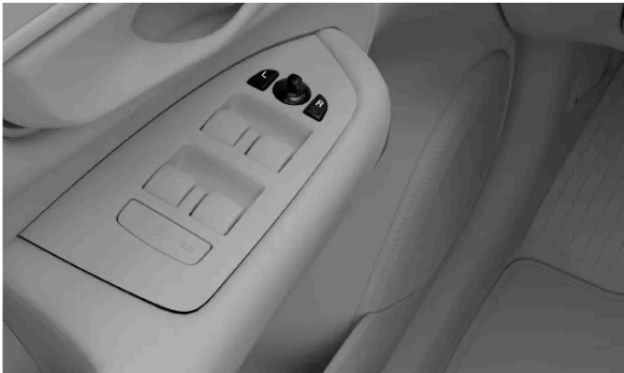
Reglage för justering av sidospeglarna
