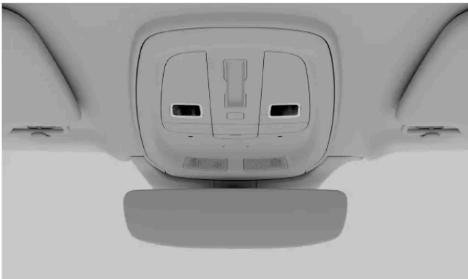
De främre läslamporna på takkonsolen
