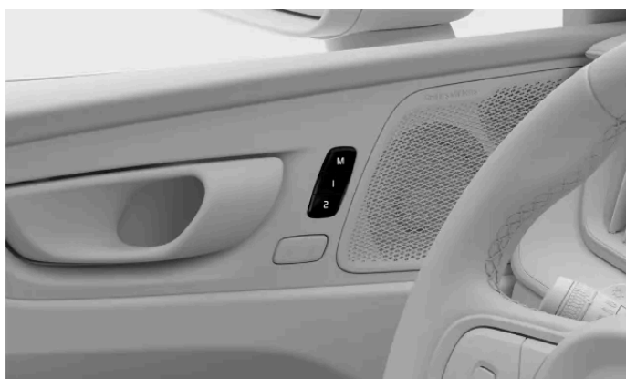
Placering av knapparna för förinställningar av sätesjustering
