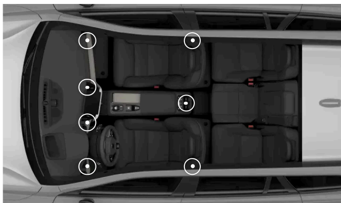
De reglerbara ventilationsmunstyckenas placering
