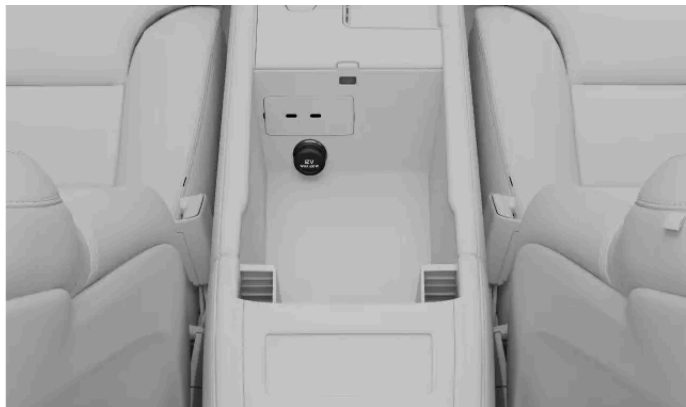
12 V-eluttaget i tunnelkonsolen
