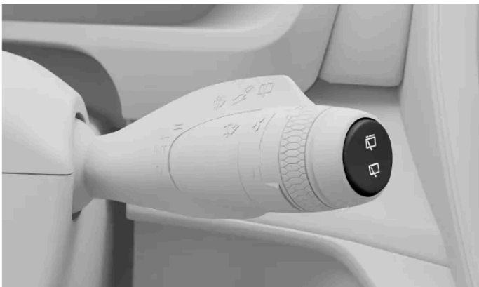
Bakrutetorkarens reglage sitter på höger rattspak.
