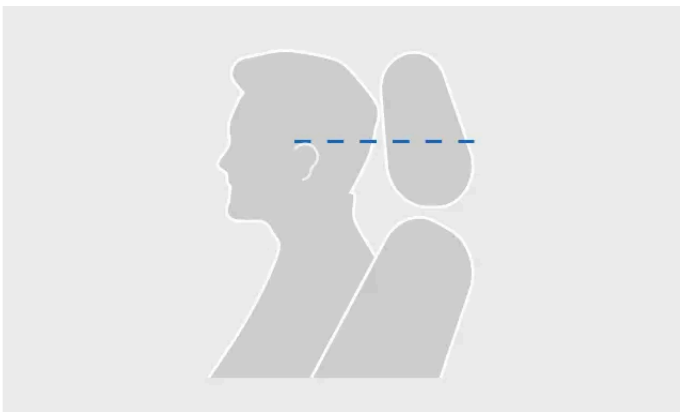
Korrekt nivå på nackstödet
