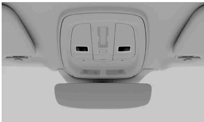
De främre läslamporna på takkonsolen
