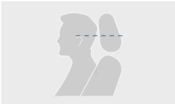
Korrekt nivå på nackstödet
