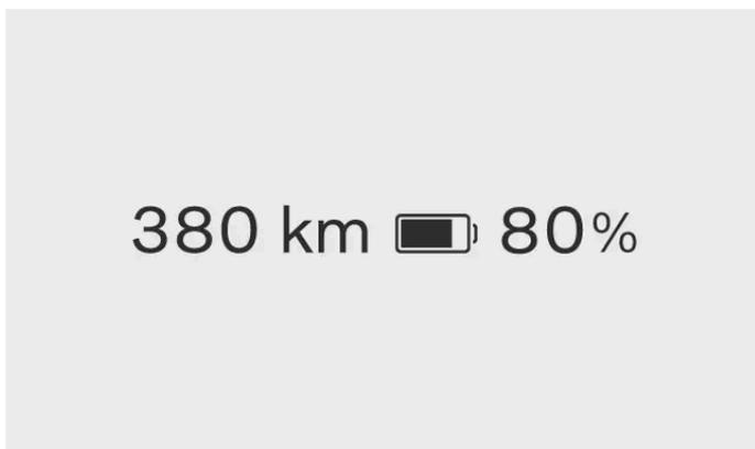
El indicador de la batería aparece en todo momento en la zona de información del conductor. El color del icono de la batería cambia según el nivel de carga restante en la batería.
