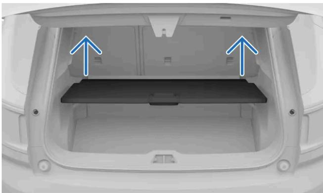
Ilustración para el desmontaje de la trampa del maletero.
