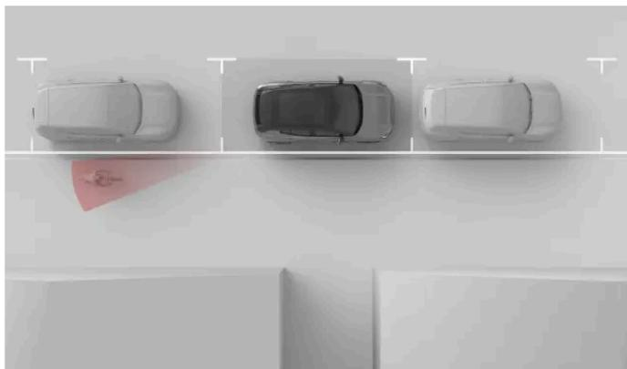
Las alertas de apertura de puertas están diseñadas para alertarle de la presencia de tráfico lateral, para evitar abrir una puerta en su trayectoria. Estas alertas pueden activarse con el automóvil parado o en movimiento muy lento<sup>[1]</sup>.
