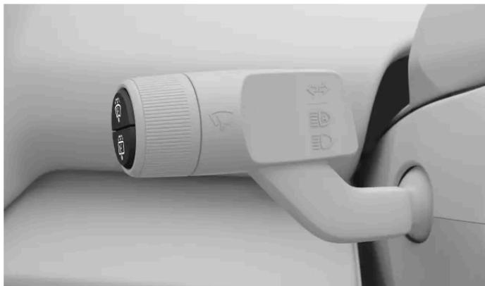
Botones del lavaparabrisas en la palanca izquierda del volante.
