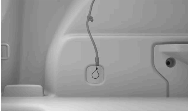
➤ El cable de carga se desbloquea del puerto de carga.
