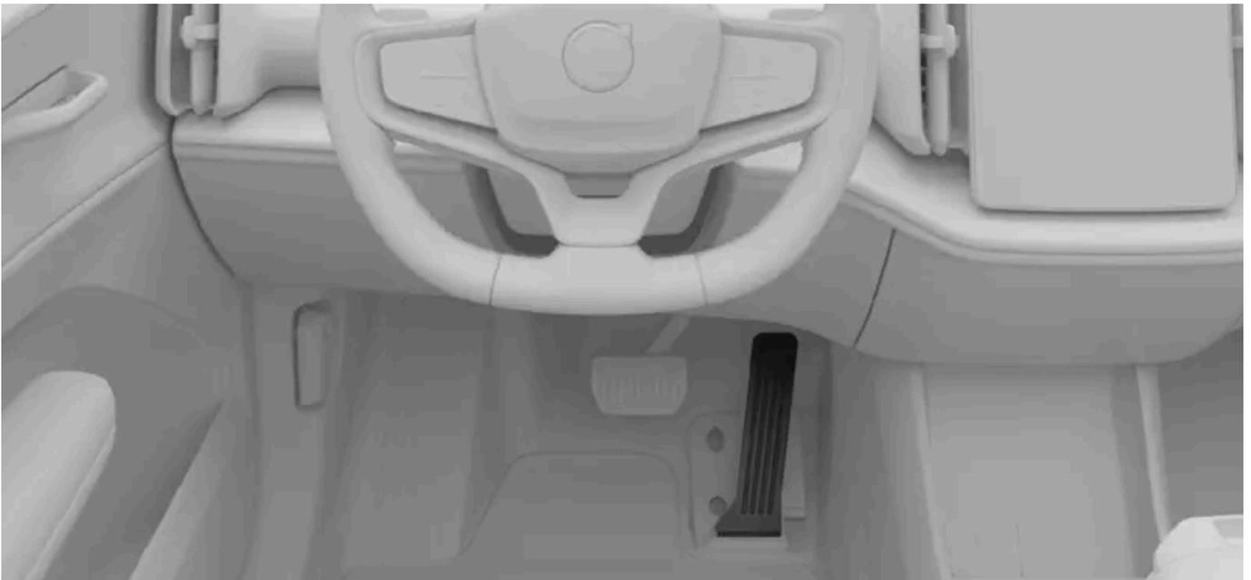
En función del uso del pedal de acelerador el comportamiento de frenado es diferente. Al pisar el acelerador el automóvil acelera con normalidad, pero al soltar el pedal se activa el frenado. Cuanto más suelte el pedal, más intenso es el frenado.
