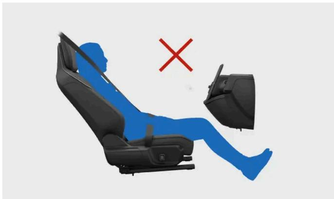
No incline el respaldo a una posición acostada. El cinturón de seguridad debe mantenerse tenso encima del hombro.
