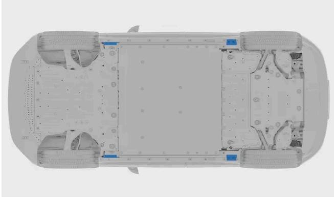
Hay dos puntos de elevación en cada lado del automóvil.
