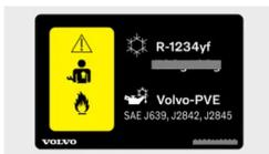
La etiqueta con información sobre los líquidos del sistema de climatización se encuentra debajo del capó, en la parte derecha del automóvil.
