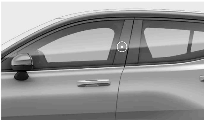
Ubicación del lector de llave en el montante de la puerta del conductor.
