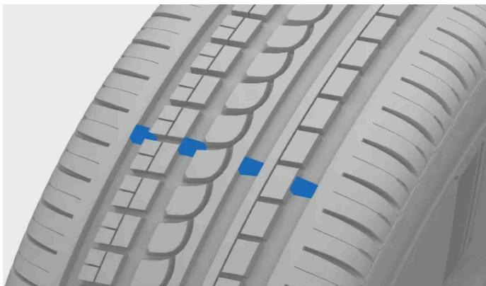
Las ranuras estrechas dispuestas a lo largo de la banda de rodadura del neumático son indicadores de desgaste. En el lateral del neumático figuran las letras TWI <sup>[1]</sup>.
