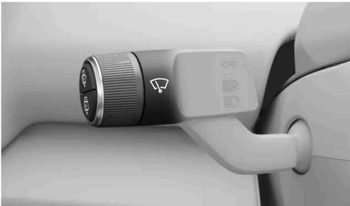
Puede controlar los limpiaparabrisas y los lavaparabrisas utilizando la rueda y los botones de la palanca izquierda del volante.
