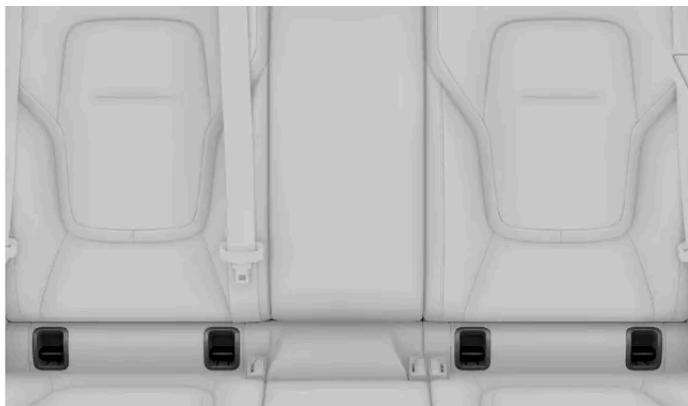
Los puntos de anclaje ISOFIX de los asientos traseros están ubicados detrás de una tapa en la parte inferior del respaldo de los asientos traseros exteriores. Hay que desplegar la tapa para acceder a los puntos de anclaje.
