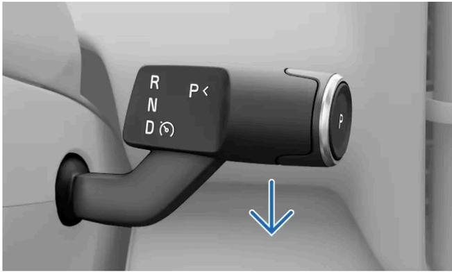
Cuando resulte necesario, mueva la palanca derecha del volante hacia abajo.
