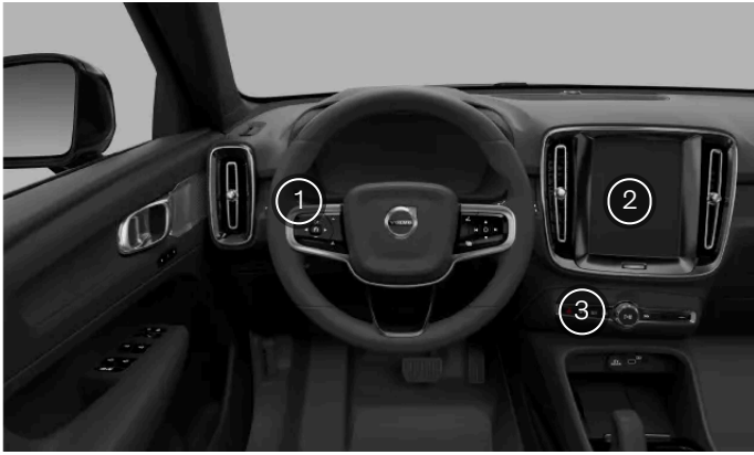
Posiciones de controles de luces exteriores
