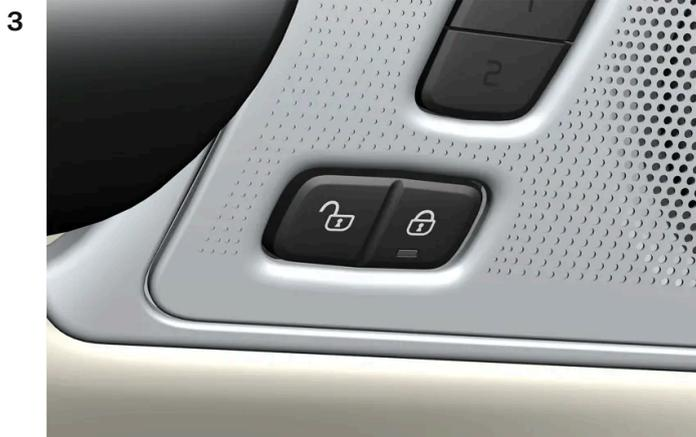
Presione el botón de cierre centralizado según se muestra en la figura.
