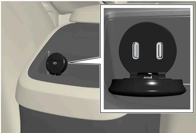
Puertos USB (tipo C) de la consola del túnel, asiento trasero.
