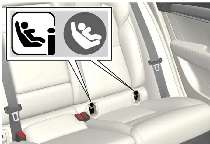
La ubicación de los puntos de fijación en el asiento trasero se indica mediante símbolos<sup>[1]</sup> en las tapas que ocultan dichos puntos.
