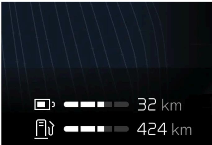
La autonomía estimada se visualiza en la pantalla del conductor.
