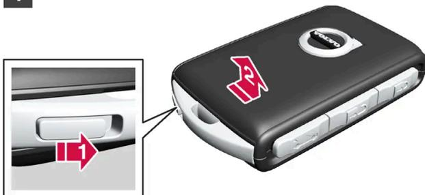
Desplace a un lado el fiador de la fijación de llavero y saque la carcasa delantera hacia afuera del soporte deslizándola.
