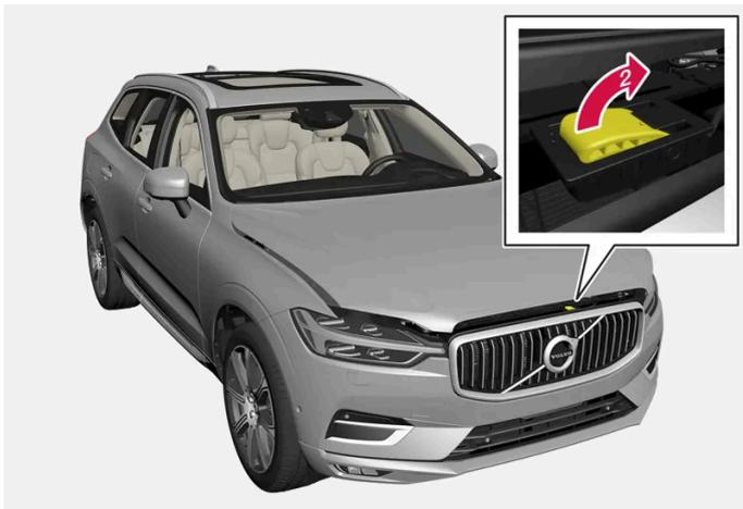
➔ Realice un barrido de izquierda a derecha en la abertura situada bajo el capó, desplace arriba y a un lado para soltar el fiador y levante el capó.
