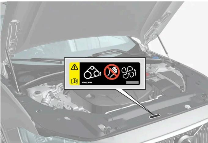
Ubicación de la etiqueta de advertencia del compartimento del motor. El diseño del compartimento del motor puede variar según el modelo y la variante de motor.
