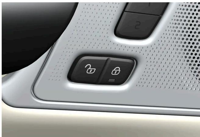
Presione el botón de cierre centralizado según se muestra en la figura.
