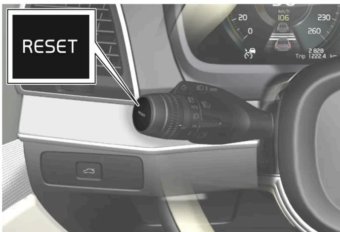
1 Efectúe una pulsación prolongada en el botón RESET de la palanca del volante.
