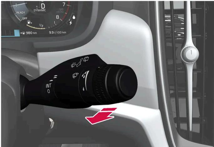
Función de lavado, palanca derecha del volante.
