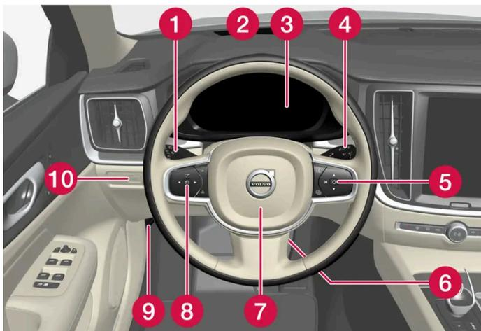
**1** Luces de posición, luces diurnas, luces de cruce, luces largas, intermitentes, luz antiniebla trasera, puesta a cero de cuentakilómetros parciales
