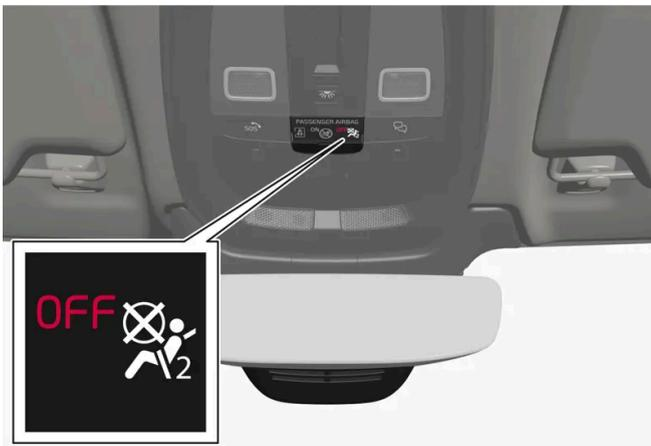
➤ En la consola del techo aparece un mensaje de advertencia y un símbolo para indicar que el airbag del asiento del acompañante está desconectado.
