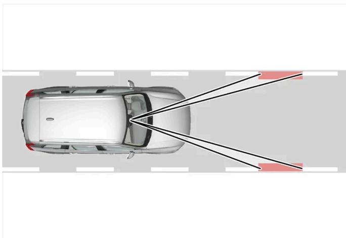
El sistema Driver Alert lee el emplazamiento del automóvil dentro del carril.
