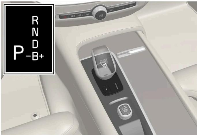
Vista general de la palanca de cambios y el patrón de cambios en la pantalla del conductor.
