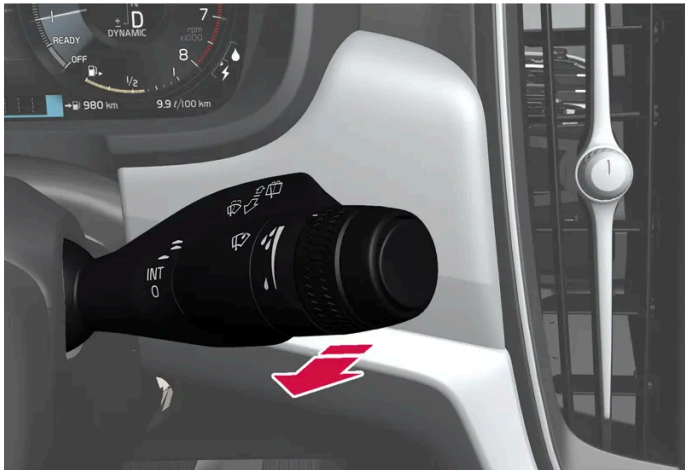
Función de lavado, palanca derecha del volante.
