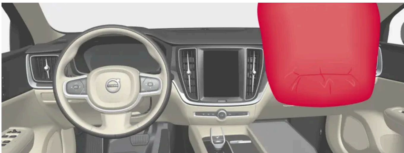
Airbag en el asiento delantero del acompañante.
