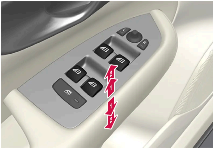
Accionamiento de los elevalunas eléctricos.
