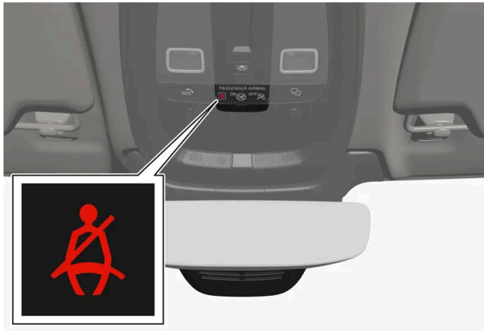
Aviso luminoso en la consola de techo.
