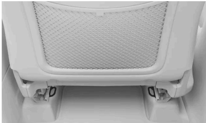
Los puntos de anclaje inferiores pueden localizarse detrás de las guías del suelo de los asientos delanteros.
