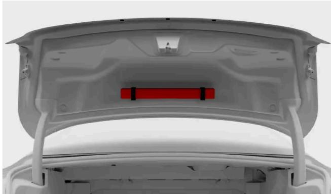
El triángulo de advertencia se encuentra en el interior de la compuerta del maletero. Abra el compartimento girando las manillas hasta que queden en posición vertical y luego tirando de ella.
