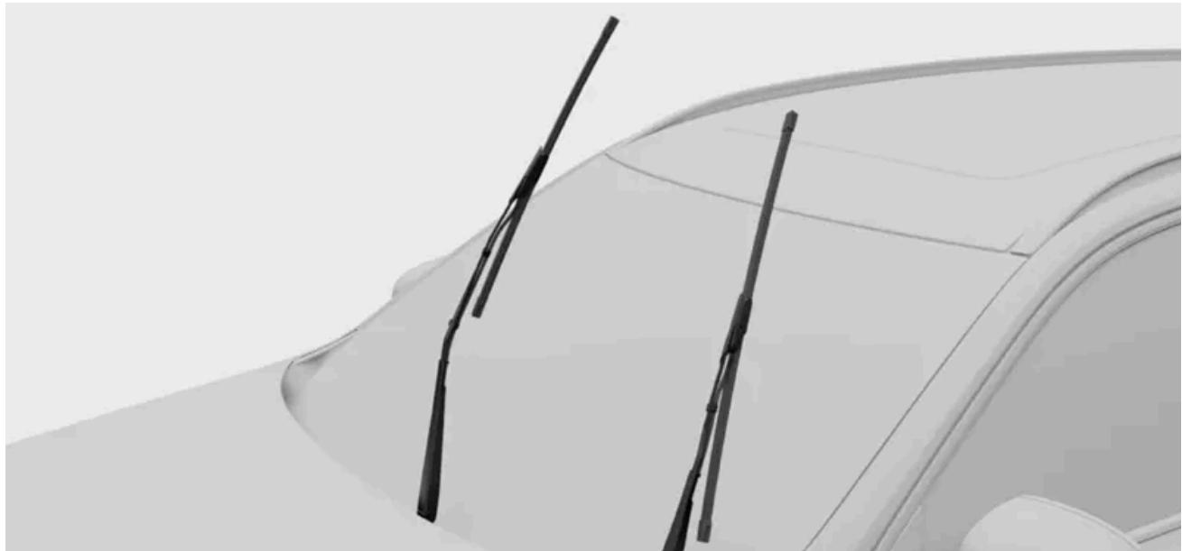
Pliegue los limpiaparabrisas hacia arriba y sepárelos del parabrisas.
