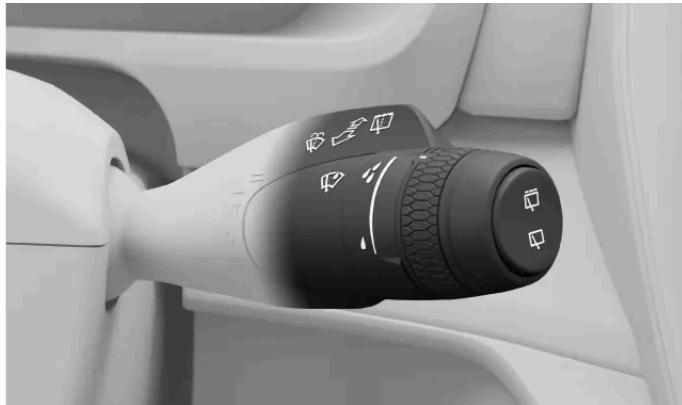
Los limpiaparabrisas y los lavaparabrisas se controlan con la palanca derecha del volante.
