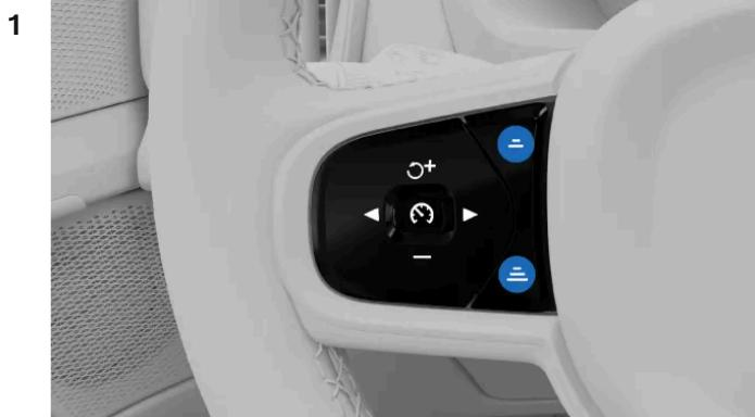
Ajuste el intervalo de tiempo a los vehículos que circulan por delante utilizando los botones del volante.
