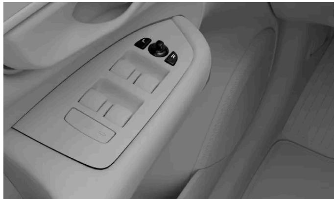
Controles para ajustar los retrovisores exteriores
