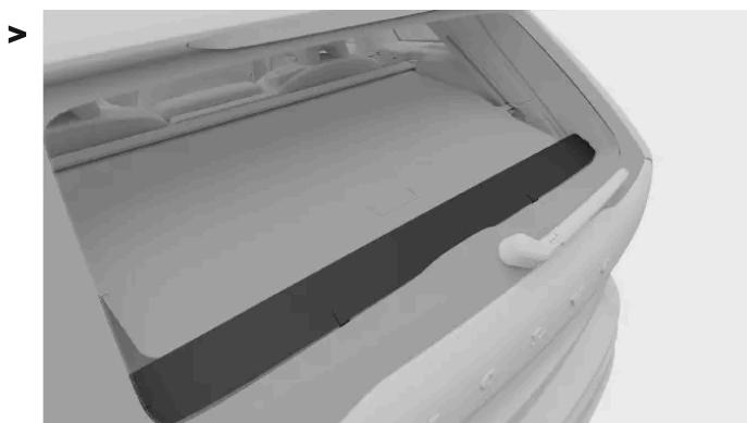
La cubierta de la compuerta del maletero está instalada y cubre el compartimento de almacenamiento del maletero.
