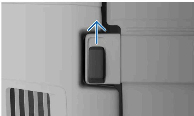
En los extremos de la cubierta de equipajes hay botones de bloqueo. Mueva el botón de un lateral hacia delante y manténgalo en esa posición mientras levanta el extremo de la cubierta. Haga lo mismo con el otro extremo.
