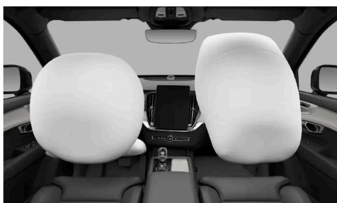
El lado del conductor y el lado del pasajero tienen cada uno un airbag frontal. El airbag del conductor está integrado dentro del volante y el airbag del acompañante está integrado detrás de un panel situado encima de la guantera.
