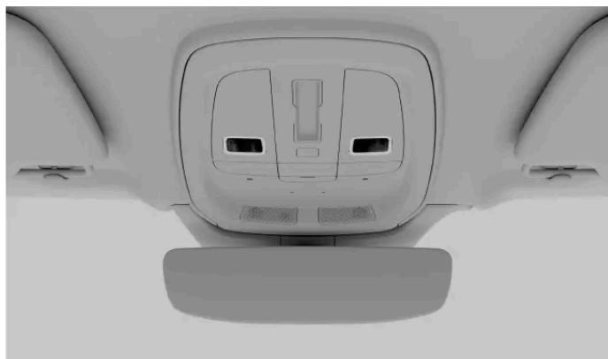
Las luces de lectura delanteras en la consola del techo
