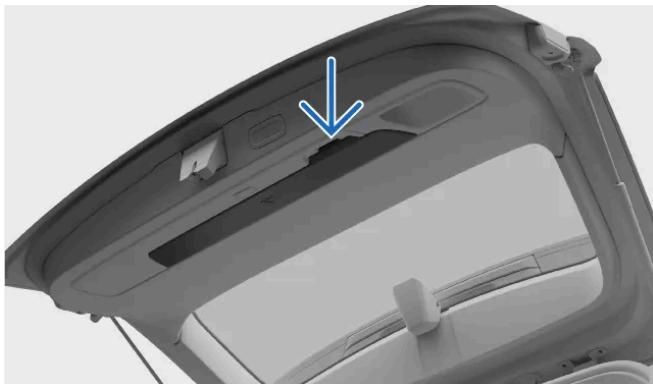
El triángulo de advertencia se encuentra en el interior de la compuerta del maletero. Tire de la manilla para abrirla.
