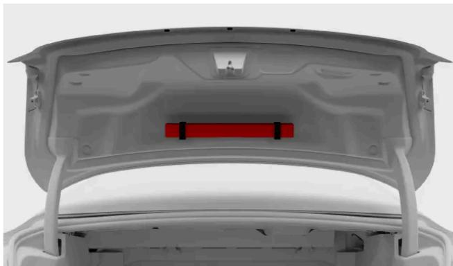
El triángulo de advertencia está fijado con dos abrazaderas en el interior de la compuerta del maletero.
