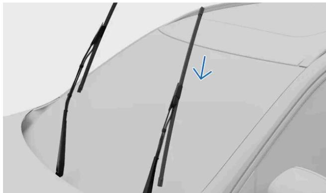
Compruebe que la escobilla del lado del conductor sea más larga que la del lado del acompañante. Deslice la escobilla en el brazo limpiaparabrisas. Asegúrese de que el pasador del brazo del limpiaparabrisas entra en el orificio de la escobilla. Introduzca la escobilla en el brazo del limpiaparabrisas hasta que escuche un clic.
