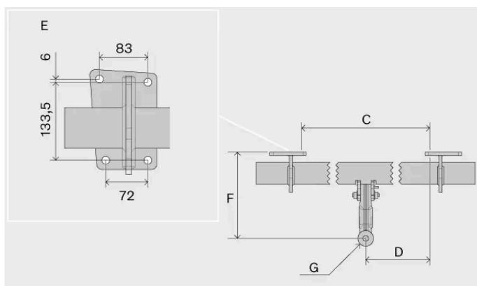
Dimensiones, puntos de fijación en mm (pulgadas)
