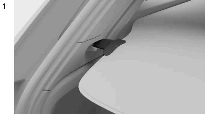
Levante y tire del extremo de la pantalla de la cubierta de equipajes por el asa para desbloquearla. Esto permite que la pantalla se retraje.
