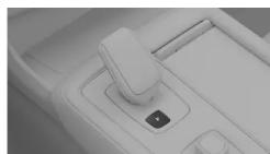
Cuando se selecciona P, la caja de cambios se bloquea mecánicamente para evitar cambios de marcha accidentales.
