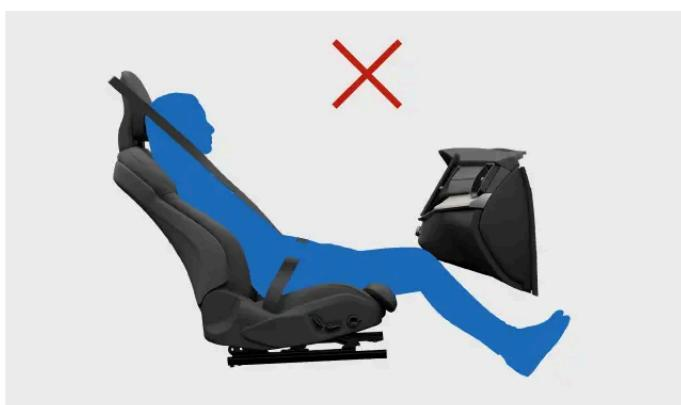
No incline el respaldo a una posición acostada. El cinturón de seguridad debe mantenerse tensado encima del hombro.
