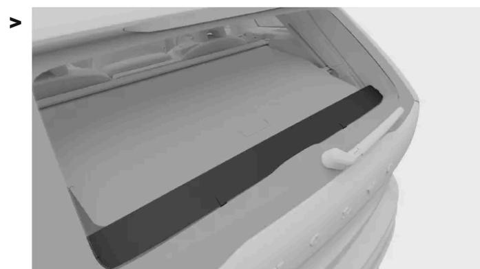
La cubierta de la compuerta del maletero está instalada y cubre el compartimento de almacenamiento del maletero.
