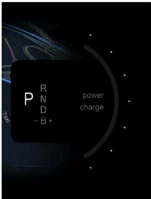
El modo de conducción seleccionado se muestra encima de la marcha seleccionada en la pantalla de conducción.
