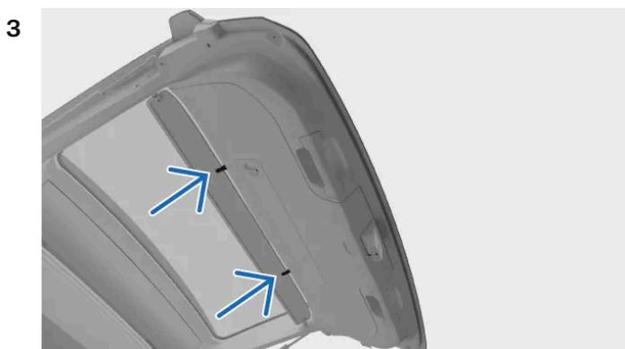
Presione las dos pinzas del lado largo de la cubierta de la compuerta del maletero hacia arriba y fíjelas en su posición en la compuerta del maletero.
