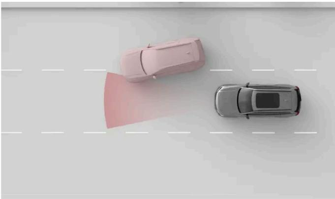
La zona de detección del radar delantero tiene una anchura limitada. Si otro vehículo se le echa encima, la detección puede producirse relativamente tarde y su automóvil respondería de forma brusca.
