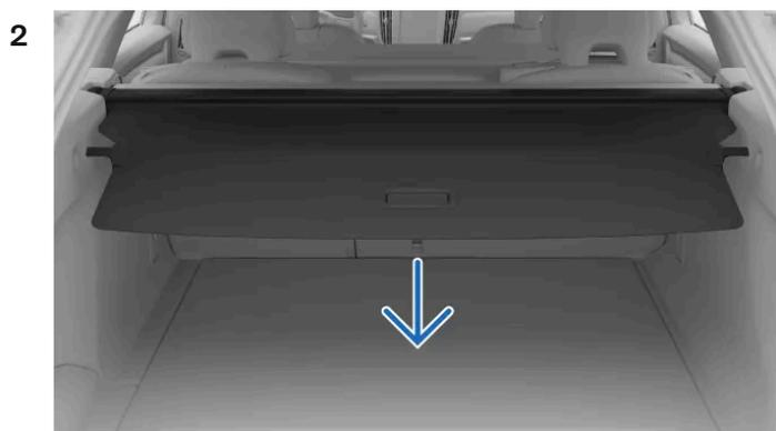
Tire del asa de la pantalla de la cubierta de equipajes por encima de los paneles laterales del maletero.
