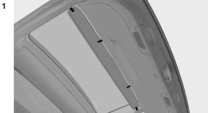
Introduzca uno de los pasadores de la cubierta de la compuerta del maletero en el soporte de un lado de la compuerta del maletero.
