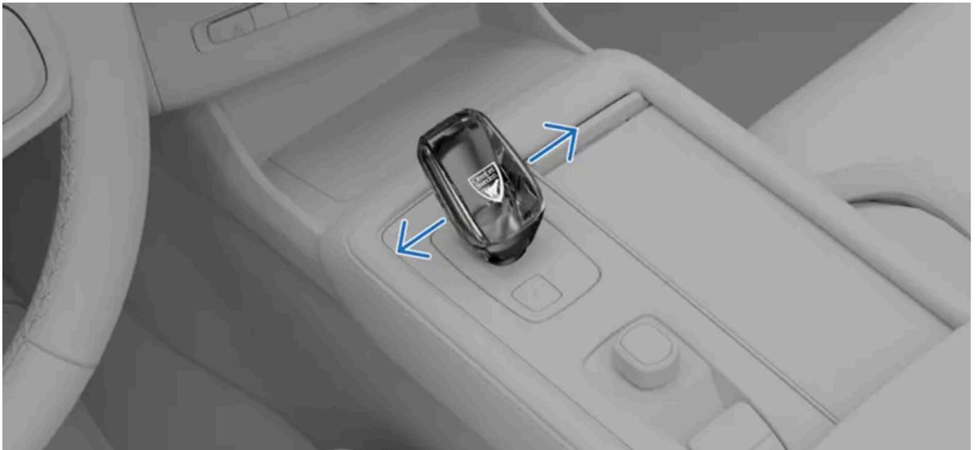
Después de seleccionar la marcha B, puede cambiar manualmente de marcha moviendo el selector de marcha hacia la izquierda o hacia la derecha.
