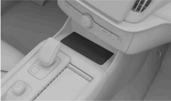
Para usar el cargador inalámbrico, su dispositivo debe tener la certificación de cumplimiento de la norma de carga inalámbrica Qi. Compruebe también que la carga inalámbrica esté activada tanto en el dispositivo <sup>[1]</sup> como en el cargador. Puede activar el cargador en la pantalla central.
