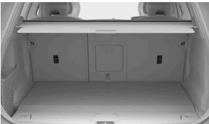
Las posiciones de los puntos de anclaje superiores de los asientos traseros se indican con el símbolo de la sujeción superior.
