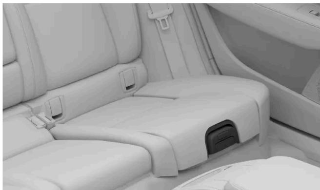
Tire del tirador de la parte delantera del cojín del asiento para desbloquearlo.
