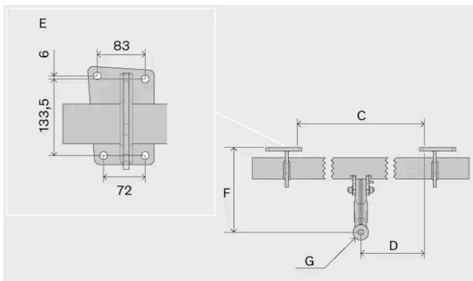
Dimensiones, puntos de fijación en mm (pulgadas)
