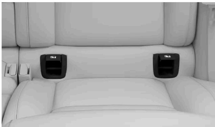
Posición de los puntos de anclaje ISOFIX de los asientos traseros exteriores
