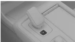
Cuando se selecciona P, la caja de cambios se bloquea mecánicamente para evitar cambios de marcha accidentales.
