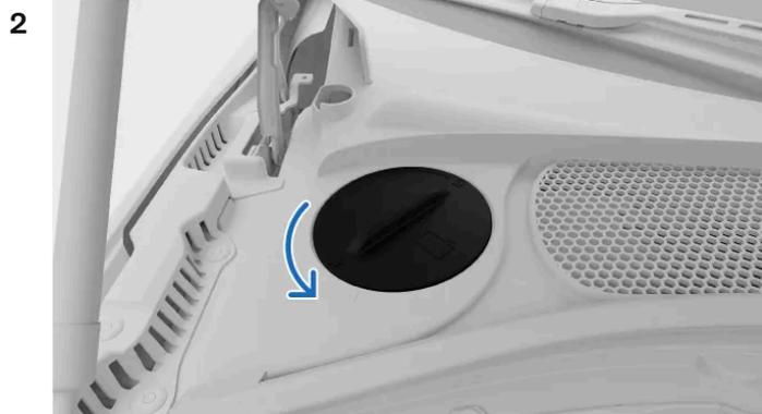
Abra la trampilla del panel en la esquina superior izquierda del compartimento del motor para acceder al recipiente del refrigerante.
