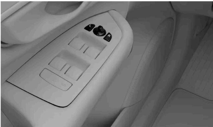
Controles para ajustar los retrovisores exteriores
