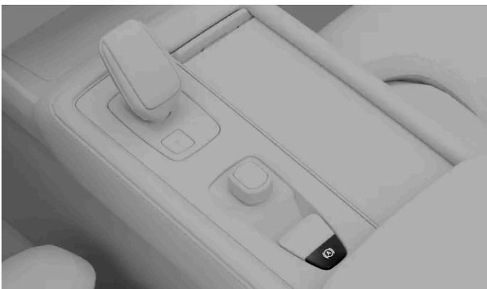
1 Pulse el botón de retención automática de la consola del túnel.
