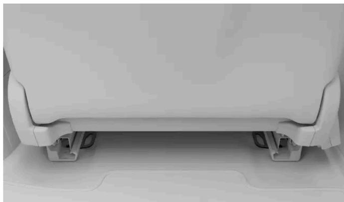
Les points de fixation de sangle inférieure se trouvent à l'arrière des rails au plancher des sièges avant.
