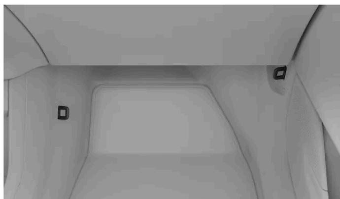
Avec l'accessoire de sangle inférieure avant<sup>[1]</sup>, des points de fixation sont également situés sur les côtés de la cave à pieds du siège passager avant.
