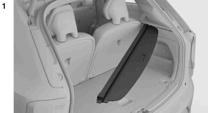
Placez l'une des extrémités du cache-bagages dans le renforcement dans la rainure d'un côté du coffre. Le renforcement est signalé par une ligne. Vérifiez que l'extrémité du cache-bagages est alignée sur la ligne de repère.
