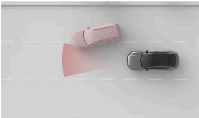
La largeur de la zone de détection du radar avant est limitée. Si un autre véhicule vous fait une queue-de-poission, la détection peut se produire assez tardivement et entraîner une réponse soudaine de votre voiture.
