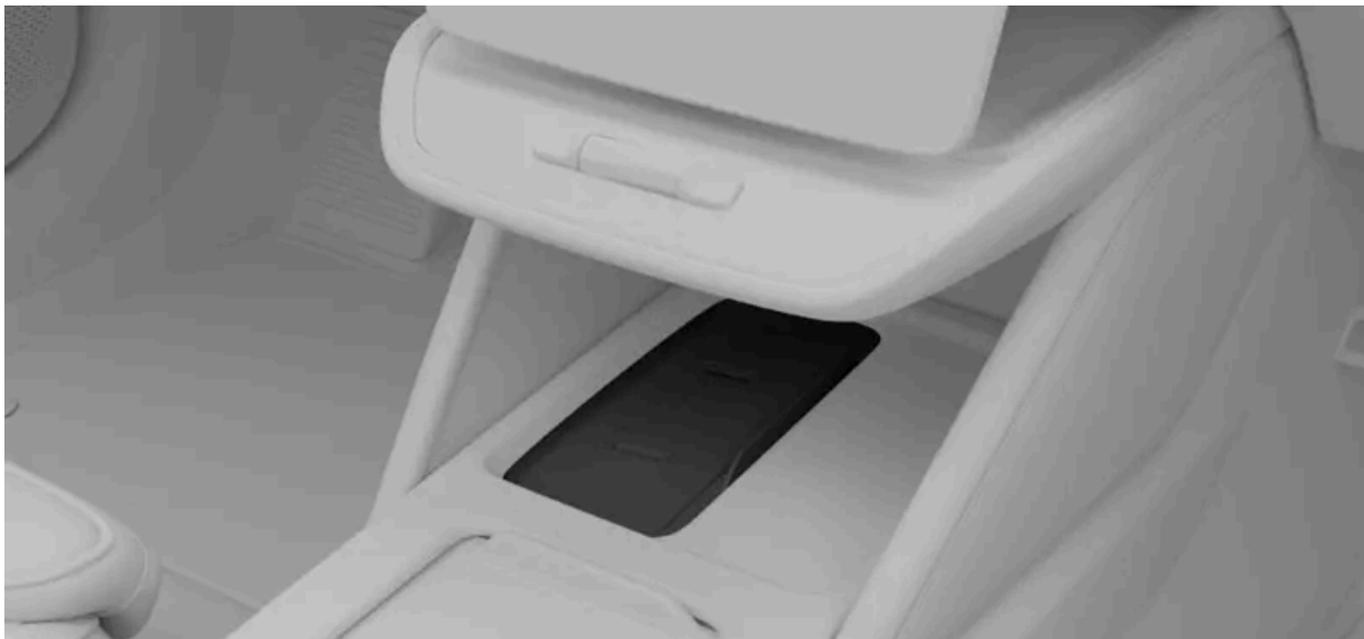
Pour utiliser le chargeur sans fil, votre appareil doit être certifié selon la norme Qi de recharge sans fil. Vérifiez également que la recharge sans fil est activée à la fois sur l'appareil<sup>[1]</sup> et sur le chargeur lui-même. Vous pouvez activer le chargeur à l'écran central.
