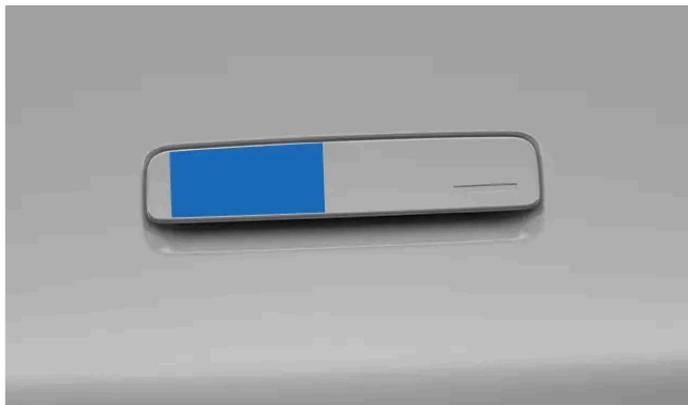
Emplacement du capteur de clé sur la poignée de porte conducteur
