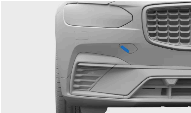
Cache de fixation d'anneau de remorquage avant
