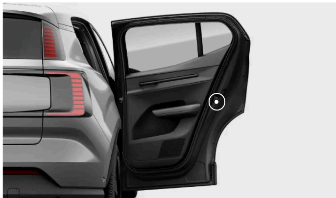
Positie van de schakelaar van het kinderslot.
