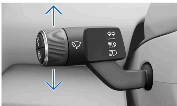
De richtingaanwijzers op de linkerhendel
