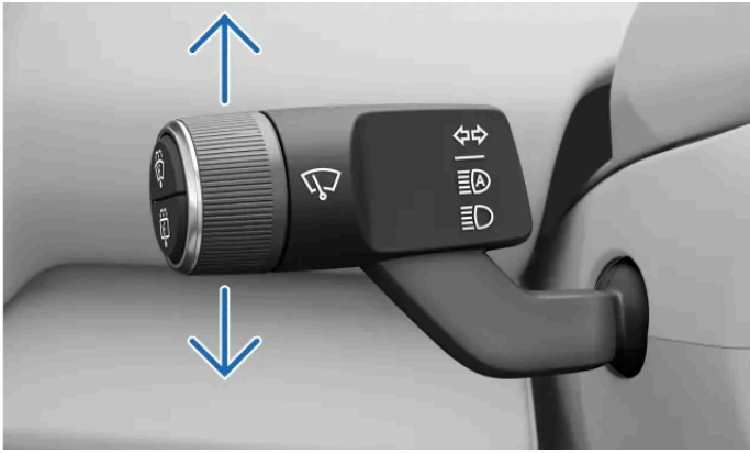
De richtingaanwijzers op de linkerhendel
