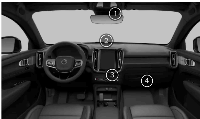
Os sensores de climatização internos
