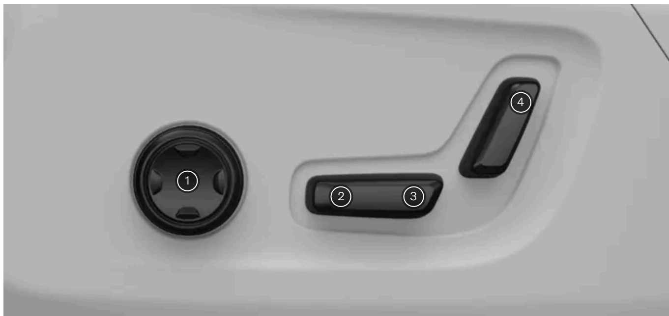
Controles na lateral do assento
