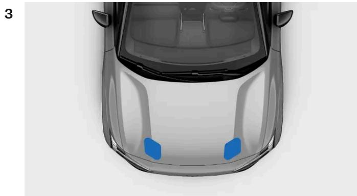
Pressione para baixo com as duas mãos a borda dianteira da tampa do capô. Certifique-se de que o capô encaixe nas travas ao mesmo tempo. Mantenha a borda dianteira plana ao fechar.
