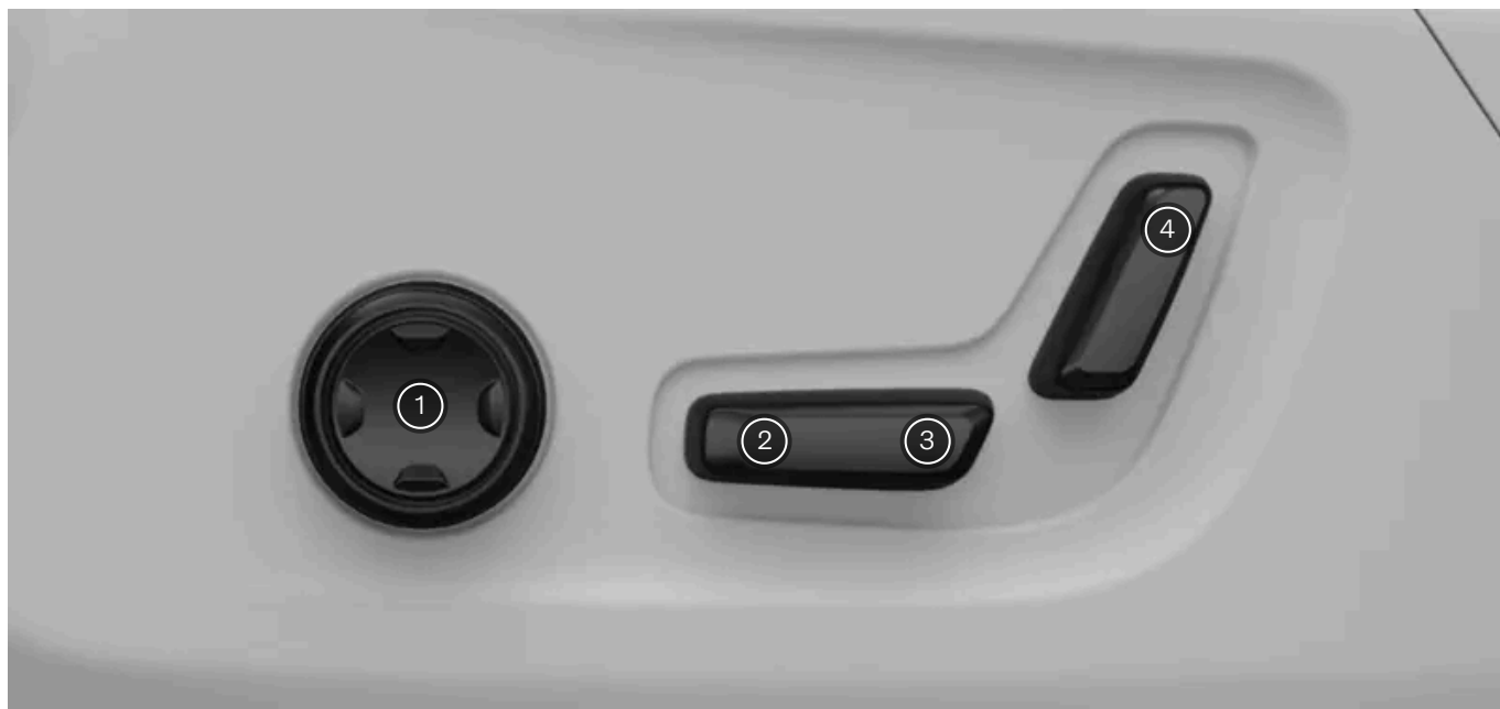
Controles na lateral do assento
