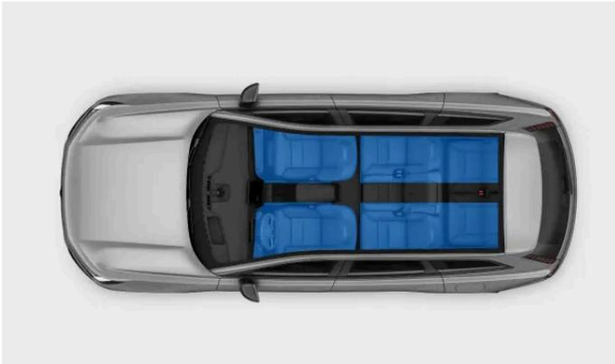
Há zonas de climatização diferentes no compartimento de passageiros do seu veículo. Todas as zonas são sincronizadas diretamente com as configurações de climatização preferidas pelo motorista, por padrão. No entanto, as zonas traseiras podem ter a própria configuração de temperatura individual.
