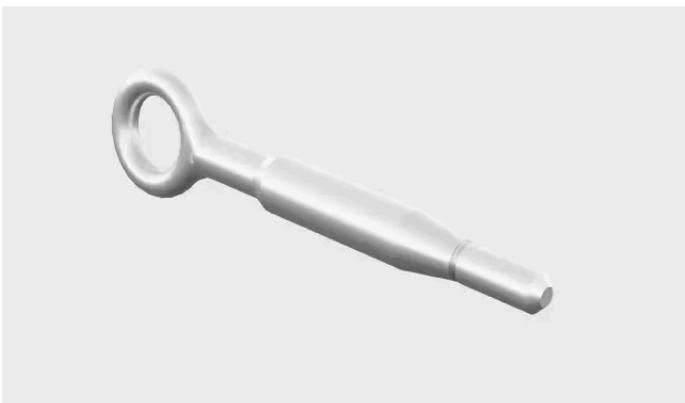
O olhal de reboque pode ser preso no para-choque do veículo para possibilitar o reboque. Ele também pode ser usado para prender objetos carregados no teto que sejam maiores do que o teto.
