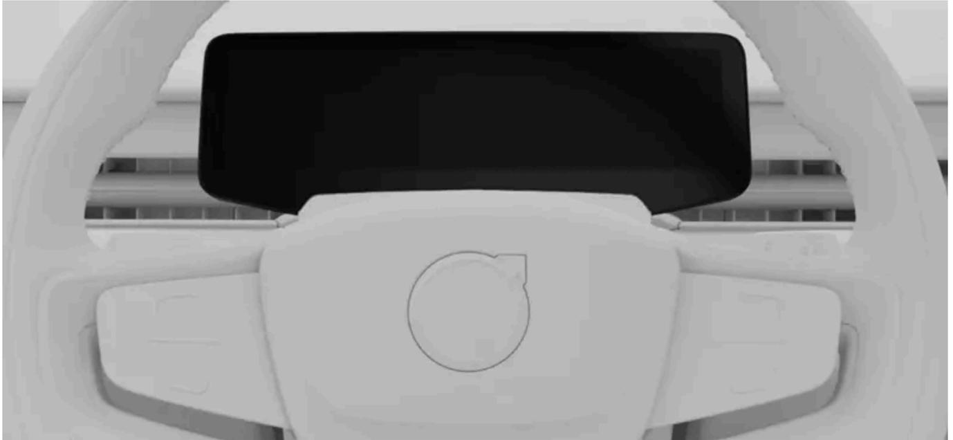
O visor do motorista se encontra na frente do motorista, atrás do volante de direção. Sua posição muda junto com o volante quando você o ajusta à sua postura de direção preferida.
