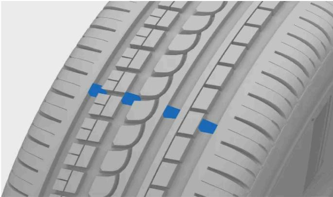
Os sulcos estreitos que percorrem longitudinalmente o padrão da banda de rodagem do pneu são indicadores de desgaste da banda de rodagem. Na lateral do pneu encontramos as letras TWI <sup>[1]</sup>.
