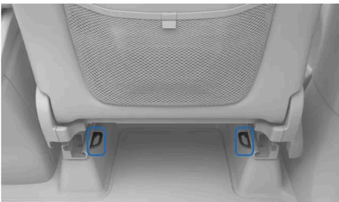
Os pontos de ancoragem do cabo inferior podem ser encontrados na parte de trás dos trilhos do assoalho dos bancos dianteiros.
