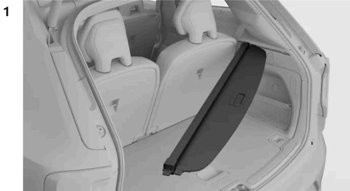
Coloque uma extremidade da tampa de carga na endentação na ranhura de um lado do porta-malas. A endentação está destacada com uma linha de marcação. Certifique-se de que a extremidade da tampa de carga esteja alinhada com a linha de marcação.
