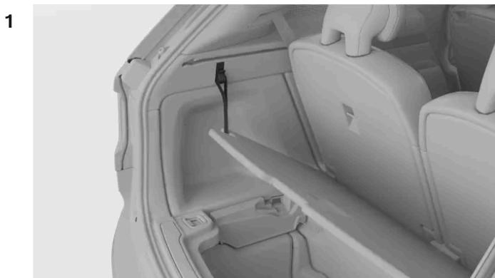
Abra a tampa do compartimento de carga com o cordão pendurado no gancho para bolsa
