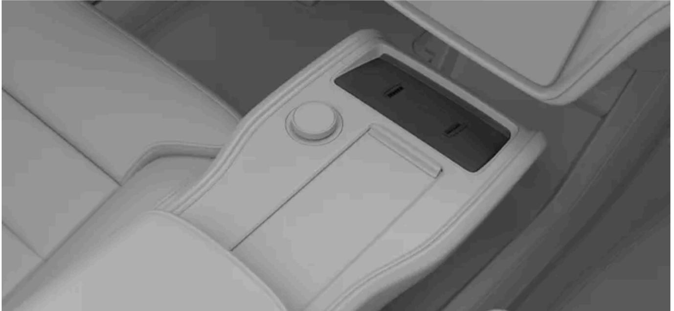
Para usar o carregador sem fio, seu dispositivo deve ser certificado pelo padrão de carregamento sem fio Qi. Verifique também se o carregamento sem fio está ativado tanto no dispositivo <sup>[1]</sup> quanto no carregador. Você pode ativar o carregador no visor central.
