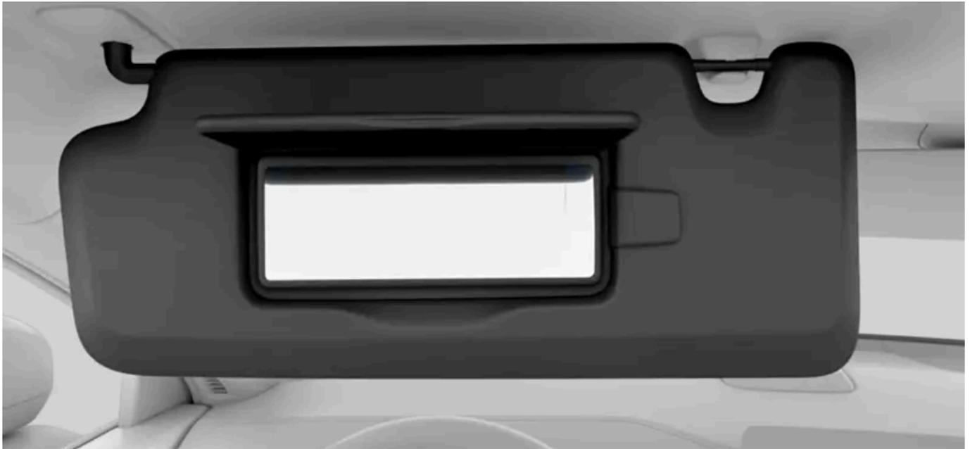
Os visores podem ser dobrados e inclinados para o lado quando necessário. Com o visor solar inclinado para o lado, você consegue estender a haste que o segura para obter melhor posicionamento.
