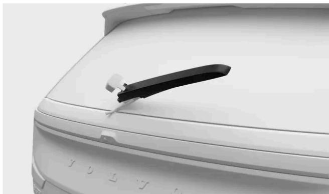
Segure o centro do braço do limpador e levante-o afastando-o do para-brisa traseiro. Você pode sentir alguma resistência no meio do caminho, essa é a posição de travamento. Você precisa puxar o braço do limpador além da posição de travamento para que ele não caia de volta no para-brisa.
