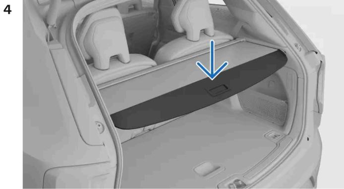
Incline a borda inferior da tampa de carga para baixo para que trave na posição nas ranhuras.
