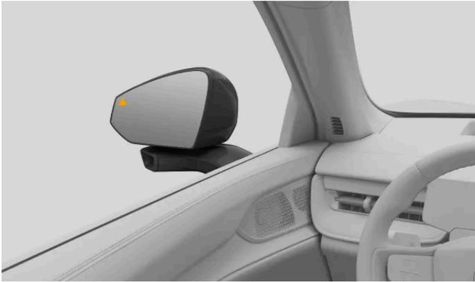
Quando o veículo detecta que o tráfego está prestes a passar próximo às laterais do veículo, uma luz é exibida no espelho retrovisor lateral. Se você começar a abrir a porta do lado do tráfego detectado, o alerta se intensificará. Um alerta sonoro pode ocorrer junto com os alertas visuais, dependendo da urgência do aviso.
