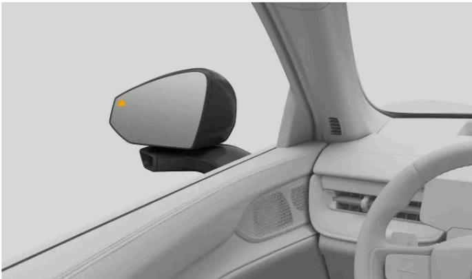
Quando um veículo é detectado em seu ponto cego ou se aproximando dele, uma luz é exibida no espelho retrovisor lateral.
