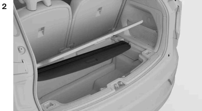
Coloque a extremidade direita da tampa de carga no suporte da tampa de carga, que está localizado no lado direito do bagageiro.
