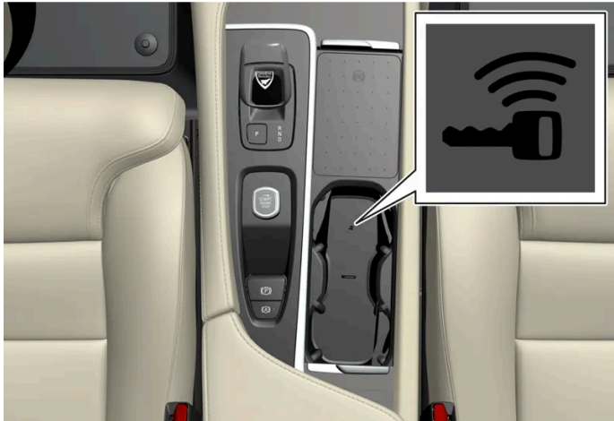
Localização do leitor no console de túnel.
