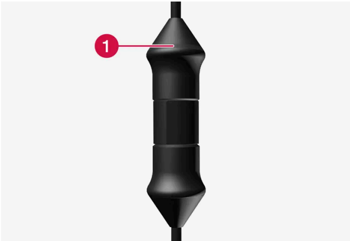
Lâmpada de LED [2] da unidade de controle
