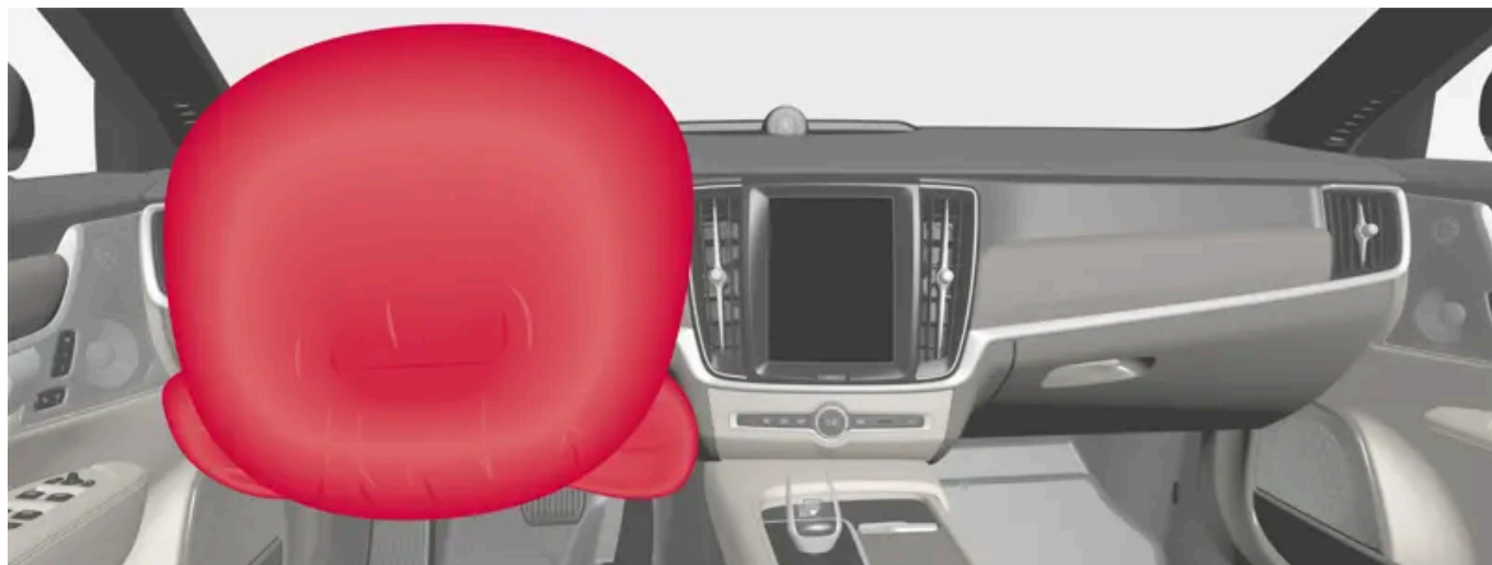
Airbag do volante e airbag do joelho [1] no lado do motorista no banco dianteiro.
