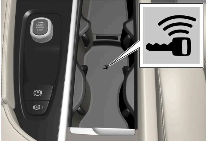
Localização do leitor no console de túnel.
