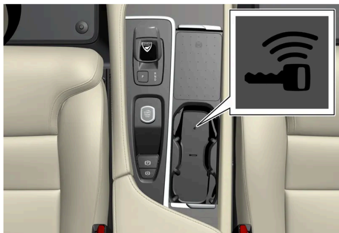
Localização do leitor no console de túnel.
