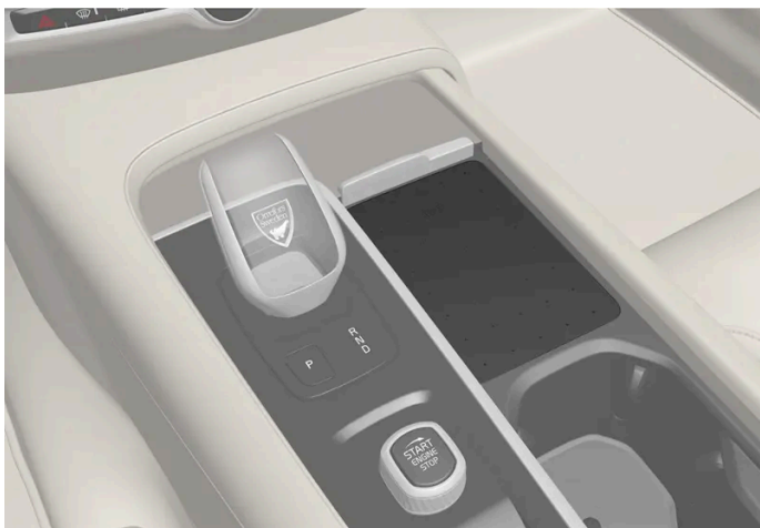
Carregar sem fio no console de túnel.
