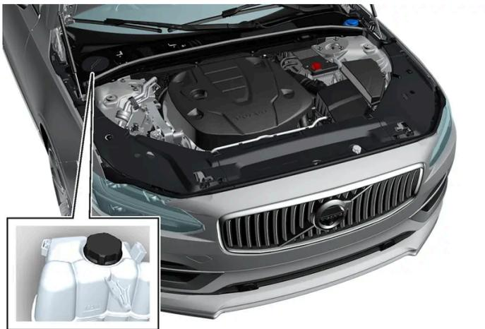
Tanque de expansão do fluido de arrefecimento, veículo com volante à esquerda.
