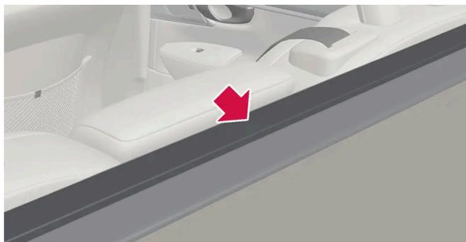
Rebata para frente o painel de cobertura dianteiro da tampa da carga para eliminar o espaço entre a tampa da carga e o encosto traseiro.
