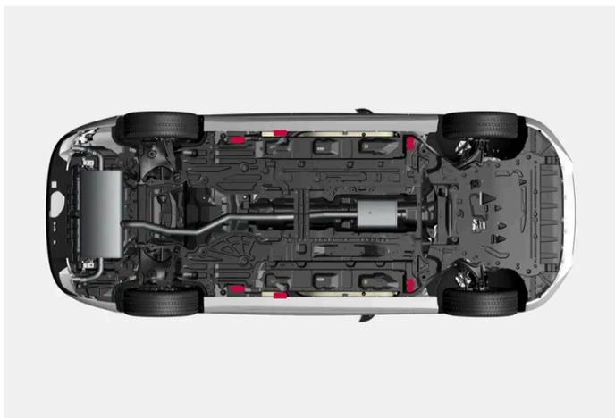
O veículo tem pontos de levantamento externos para levantamento de nível baixo e pontos de levantamento internos para levantamento de nível alto, como macaco de oficina ou braços de levantamento.
