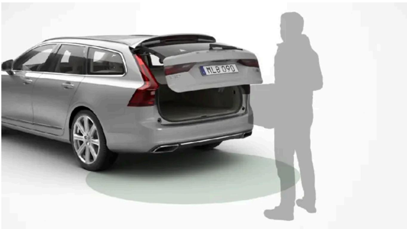
Se o veículo estiver equipado com travamento e destravamento sem chave,\* será possível destravar a tampa do porta-malas usando o movimento do pé.
