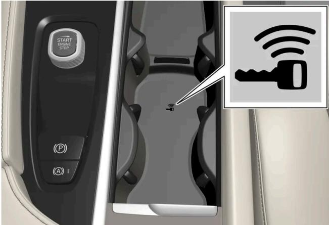
Coloque a chave no símbolo da chave no leitor de backup no porta-copos do console de túnel.
