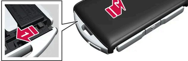
Deslize a trava que estava atrás da proteção frontal para o lado e deslize a tampa traseira para longe do suporte do chaveiro.
