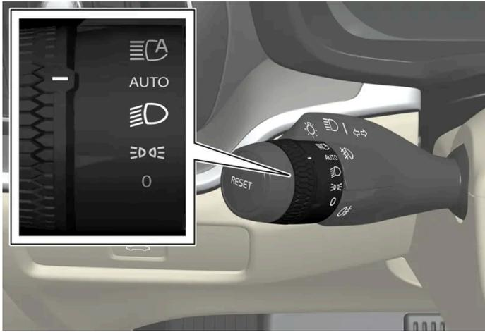
Anel rotativo na alavanca do lado esquerdo do volante.
