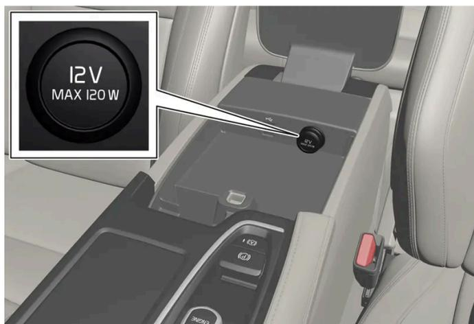
Tomada elétrica 12 V no console de túnel, banco dianteiro.
