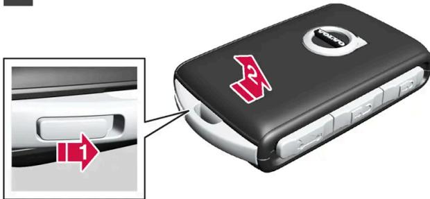
Deslize a trava do suporte do chaveiro para o lado e deslize a proteção frontal para fora do suporte.
