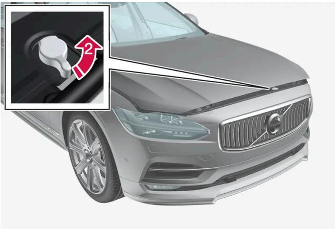
➔ Gire a alavanca sob o capô no sentido anti-horário para soltar o trinco e levantar o capô.
