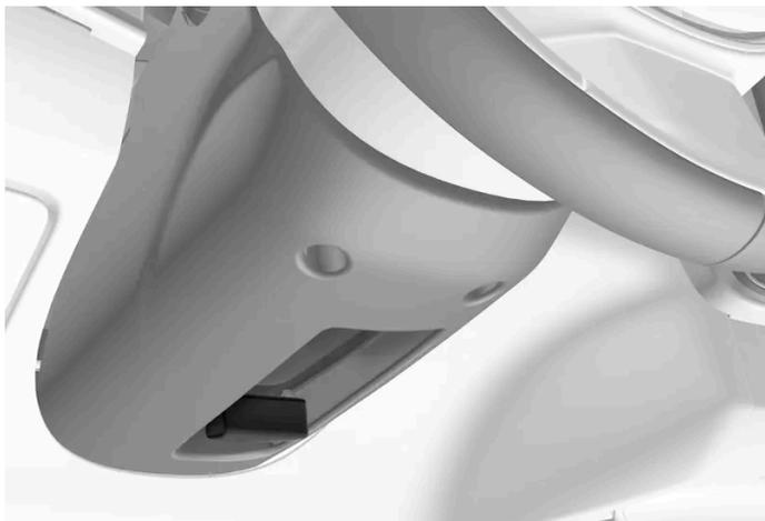
Alavanca para ajuste do volante.
