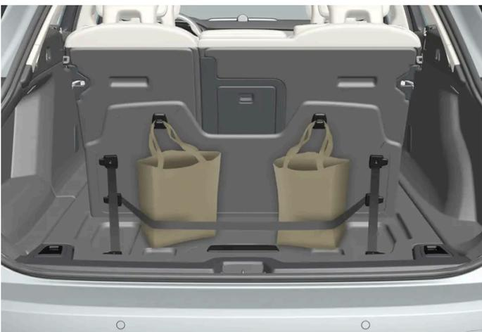
Existem dois ganchos para sacolas de compras e uma cinta elástica<sup>[1]</sup> na tampa, que faz parte da escotilha do assoalho, no compartimento de carga. A cinta pode ser montada de quatro formas diferentes.
