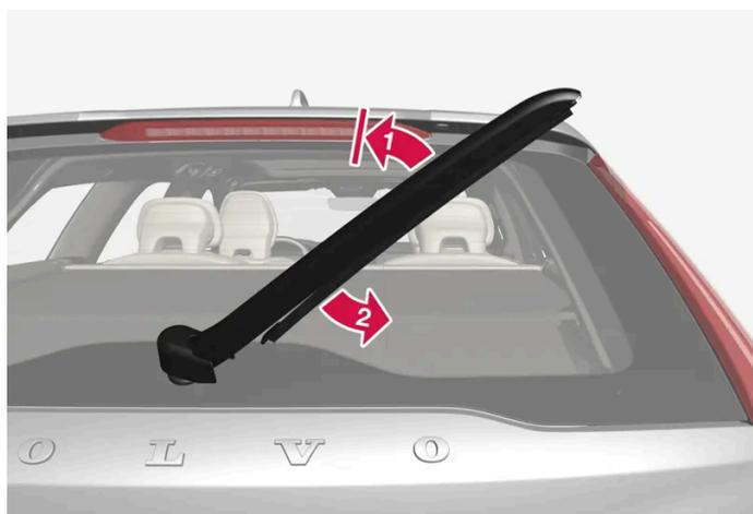
Levante o braço do limpador do para-brisa do vidro e puxe a parte inferior da palheta do limpador para a direita.
