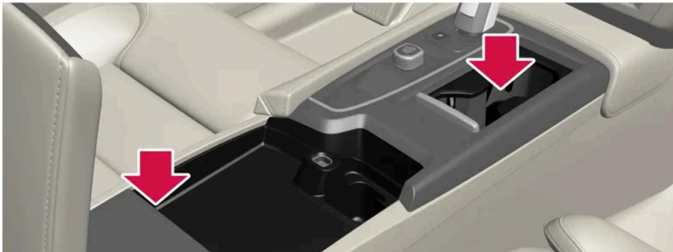
Espaços para armazenamento com porta-copos, tomada elétrica, além de entradas USB no console de túnel.
