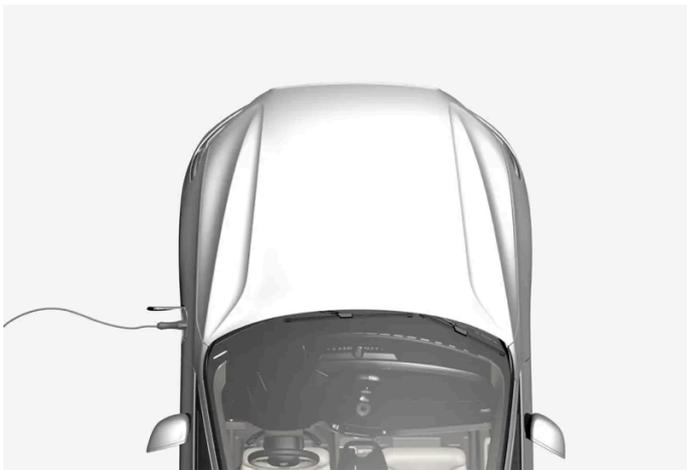
A bateria híbrida é carregada por um cabo de carregamento, mas pode ser carregada aplicando frenagem leve e usando o freio motor em posição da marcha B. A bateria híbrida também pode ser carregada com o motor a combustão interna do veículo. A bateria de arranque do veículo é carregada quando a bateria híbrida está carregando.
