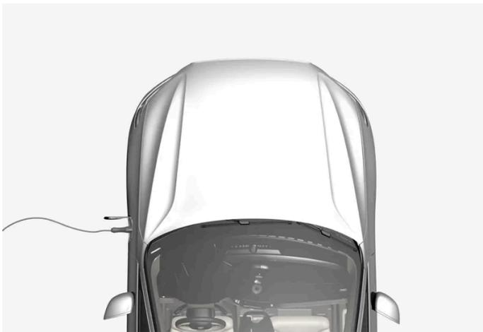
A bateria híbrida é carregada por um cabo de carregamento, mas pode ser carregada aplicando frenagem leve e usando o freio motor em posição da marcha B. A bateria híbrida também pode ser carregada com o motor a combustão interna do veículo. A bateria de arranque do veículo é carregada quando a bateria híbrida está carregando.
