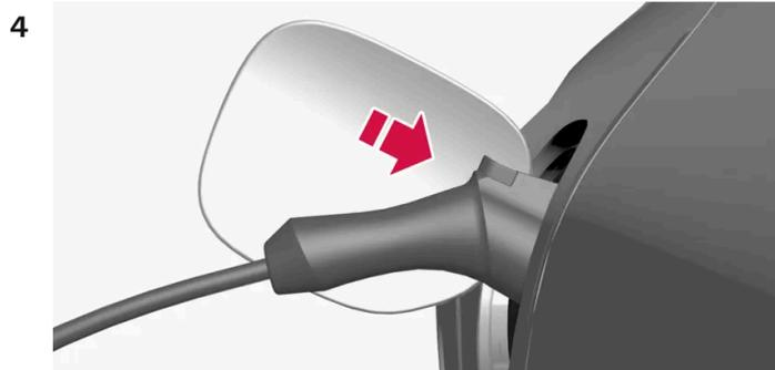
Solte a tampa de proteção da alça de carga e pressione a alça de carregamento até o fundo na tomada do veículo.
