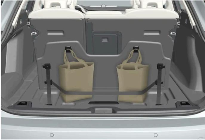
Existem dois ganchos para sacolas de compras e uma cinta elástica<sup>[1]</sup> na tampa, que faz parte da escotilha do assoalho, no compartimento de carga. A cinta pode ser montada de quatro formas diferentes.
