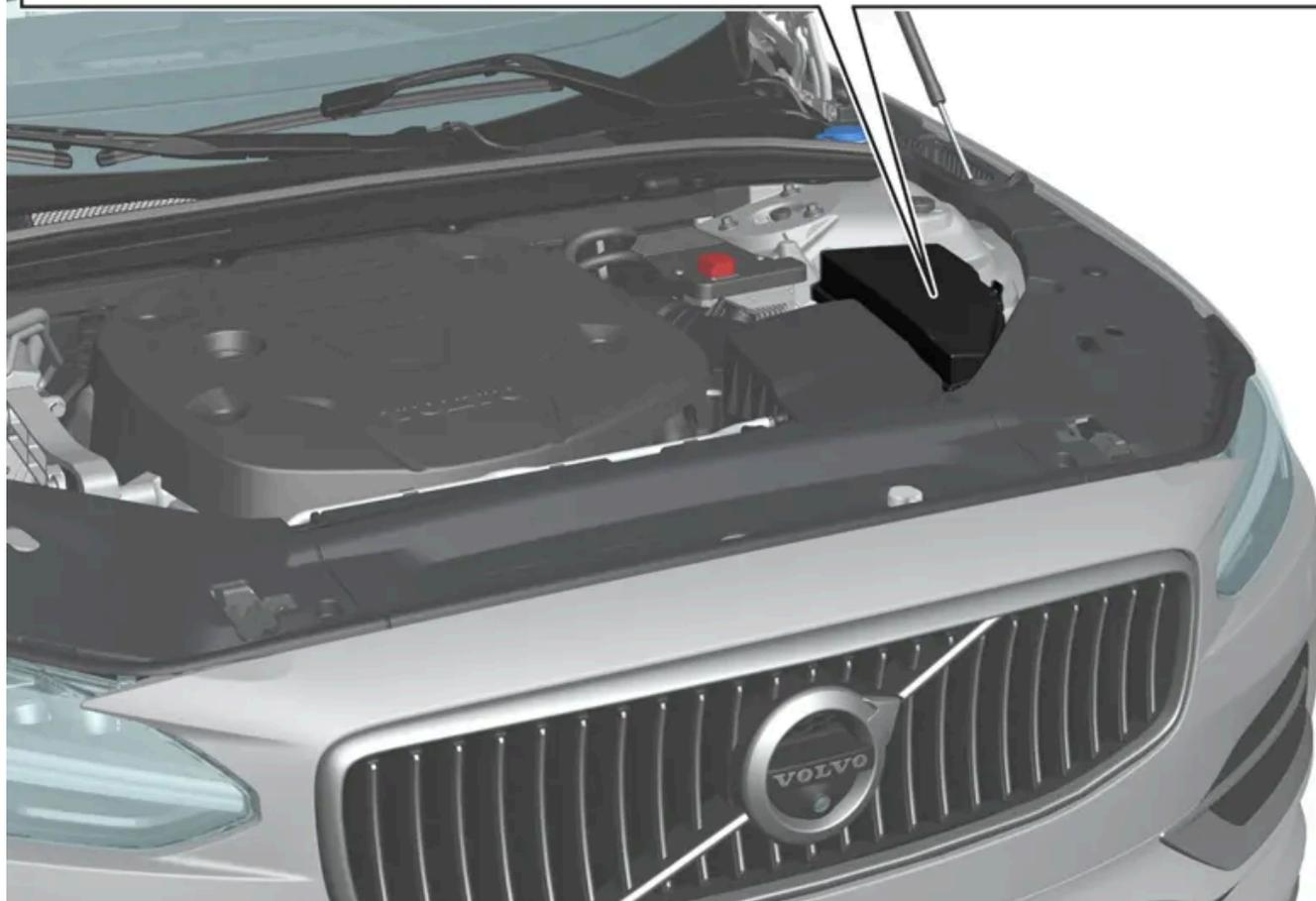
Um alicate especial está alojado na parte interna da tampa para facilitar a substituição dos fusíveis desarmados.
