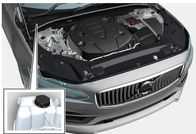
Tanque de expansão do fluido de arrefecimento, veículo com volante à direita.
