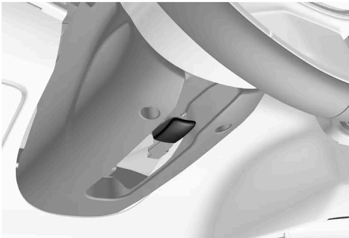
Alavanca para ajuste do volante.
