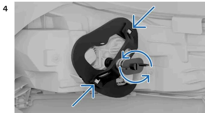
Solte o parafuso da mola girando-o no sentido anti-horário. Deixe o parafuso na ponte de suporte para poder encontrá-lo quando precisar dele novamente.
