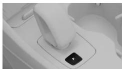
Acione manualmente o freio de estacionamento pressionando o botão do freio de estacionamento.
