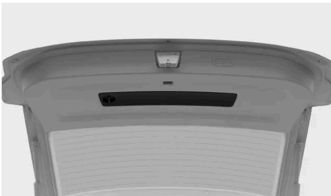
O triângulo de aviso está localizado no interior da tampa do porta-malas. Abra o compartimento girando a alça para que fique na vertical e depois puxando-a.
