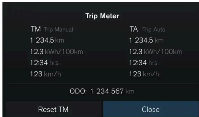
Seu veículo tem um medidor de percurso e um odômetro. O medidor de percurso pode mostrar informações sobre a distância e o tempo de condução do veículo, bem como a velocidade de condução média.
