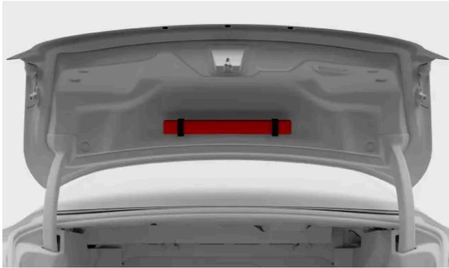
O triângulo de aviso está localizado no interior da tampa do porta-malas. Abra o compartimento girando as alças para que fiquem na vertical e depois puxando-as.
