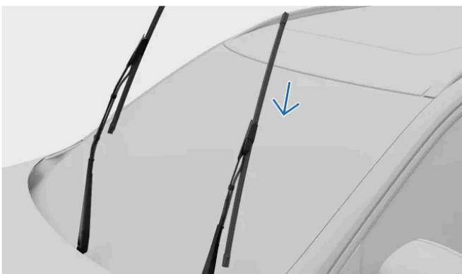
Certifique-se de que a palheta do lado do motorista seja mais longa que a palheta do lado do passageiro. Deslize a palheta do limpador para o braço do limpador. Certifique-se de que o pino no braço do limpador entre no orifício na palheta do limpador. Empurre a palheta no braço do limpador até ouvir um clique.
