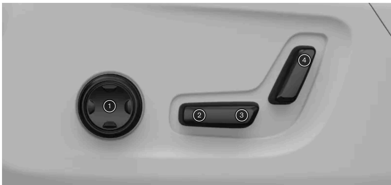
Controles na lateral do assento
