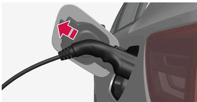
Desconecte o cabo de carregamento da tomada de entrada de carregamento do veículo e feche a escotilha.
