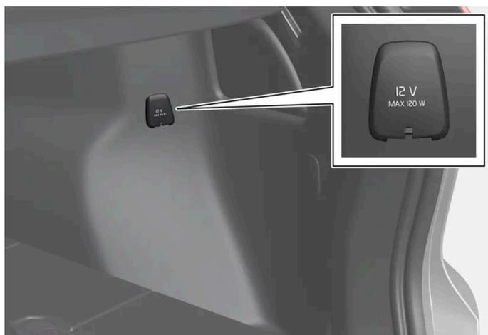
Tomada elétrica de 12 V na área de carga\*, <sup>[1]</sup>
