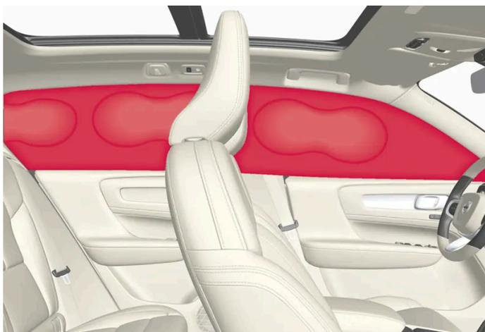
Os airbags estão montados ao longo do revestimento do teto, em ambos os lados, e ajudam a proteger o motorista e os passageiros nos assentos laterais do veículo. Os painéis estão etiquetados com IC AIRBAG.
