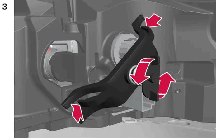
Desaparafuse o parafuso de mola no sentido anti-horário, pressione os cliques nos lados e retire a ponte de suporte. É mais fácil deixar o parafuso na ponte de suporte.
