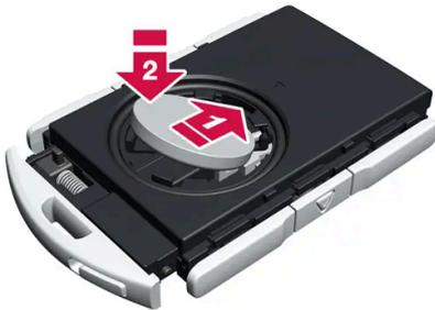
Instale uma nova bateria com o lado (+) para cima. Evite tocar com os dedos nos contatos da bateria da chave.
