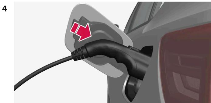
Solte a tampa de proteção da alça de carregamento e pressione a alça de carregamento até o fundo da tomada de entrada de carregamento.
