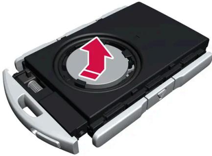
O lado (+) da bateria está virado para cima. Afrouxe a bateria pressionando em sua borda e, em seguida, levantando-a.
