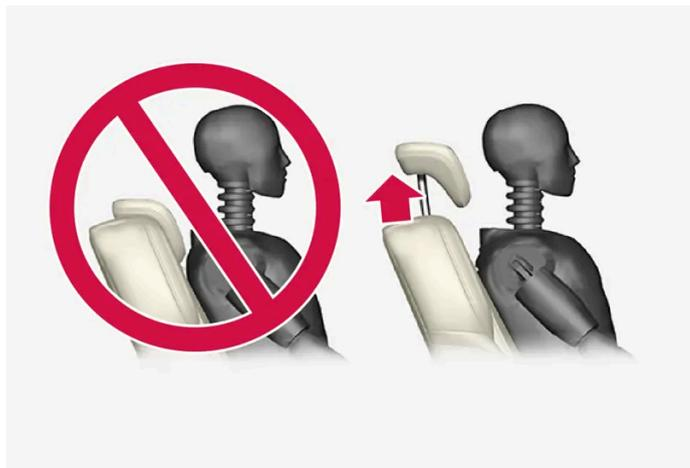
O apoio de cabeça do assento central deve ser regulado de acordo com a altura do passageiro, cobrindo preferencialmente toda a nuca. Desloque manualmente para cima, conforme a necessidade.
