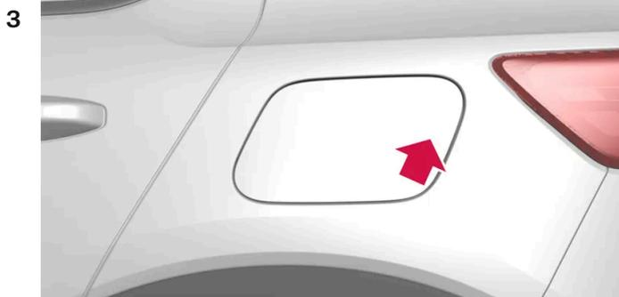
Pressione na seção traseira da tampa para abrir a escotilha de carregamento <sup>[2]</sup>.
