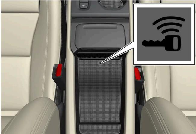
Coloque a chave no símbolo da chave no leitor de backup no compartimento de armazenamento do console de túnel.
