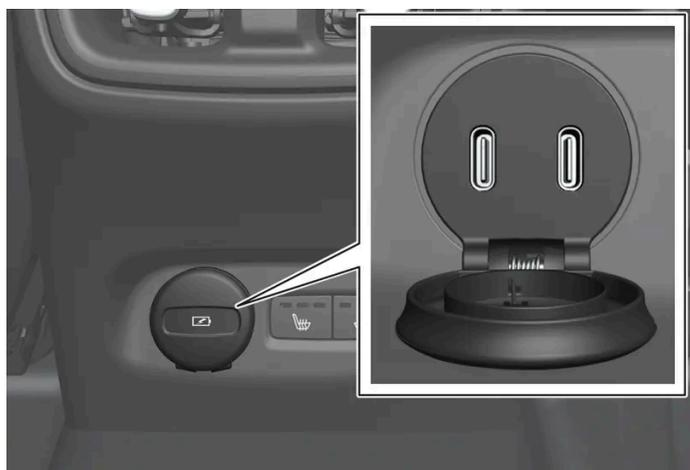
Portas USB (tipo C) no console do túnel, banco traseiro.
