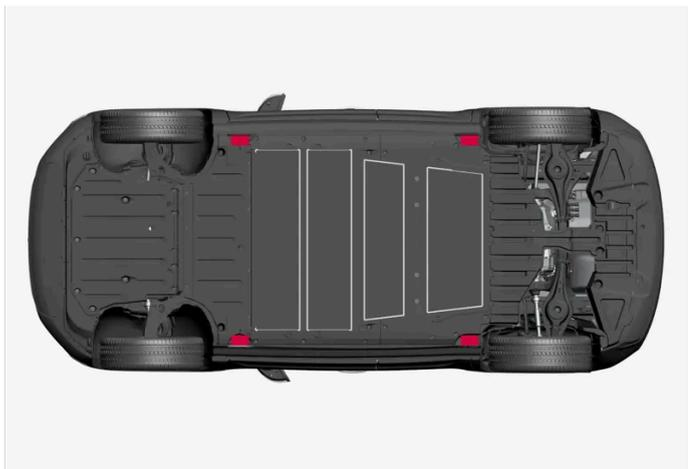
Os pontos de levantamento do veículo para levantamento com um macaco.
