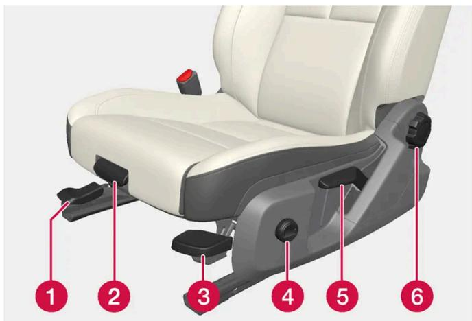
1 Ajuste o banco para frente/para trás levantando a alça e ajustando a distância em relação ao volante e aos pedais. Depois de alterar a posição, verifique se o assento ficou travado.
