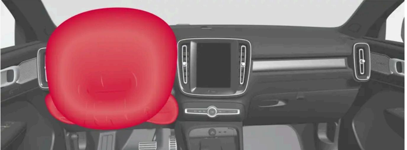
Airbag do volante e airbag do joelho<sup>[1]</sup> no lado do motorista no banco dianteiro.
