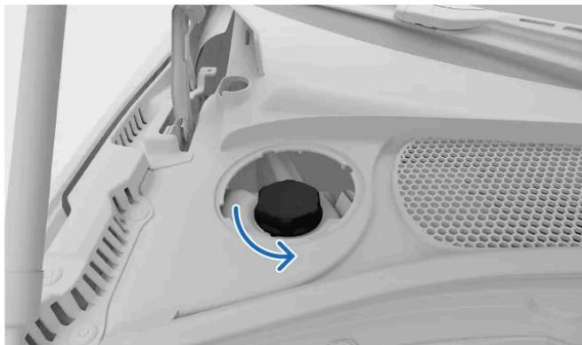
Desparafuse a tampa do recipiente do líquido de arrefecimento.
