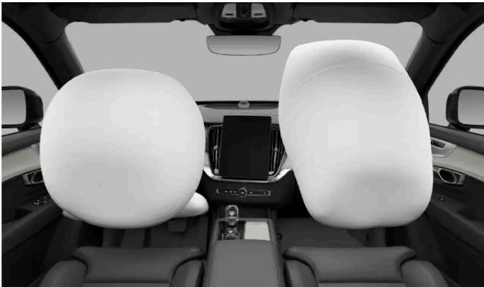
O lado do motorista e o lado do passageiro têm um airbag frontal cada. O airbag do lado do motorista fica localizado dentro do volante de direção e o airbag do lado do passageiro fica localizado atrás de um painel acima do porta-luvas.
