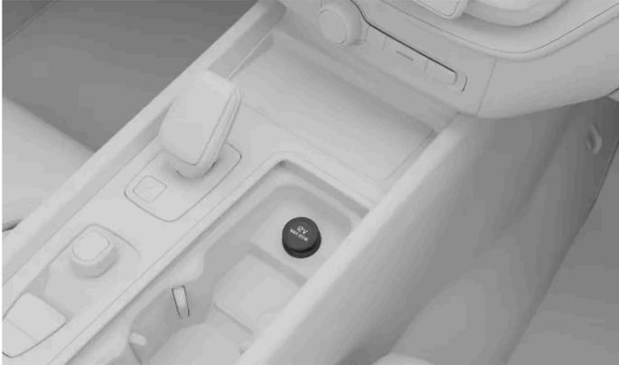
A tomada elétrica de 12 V no console de túnel
