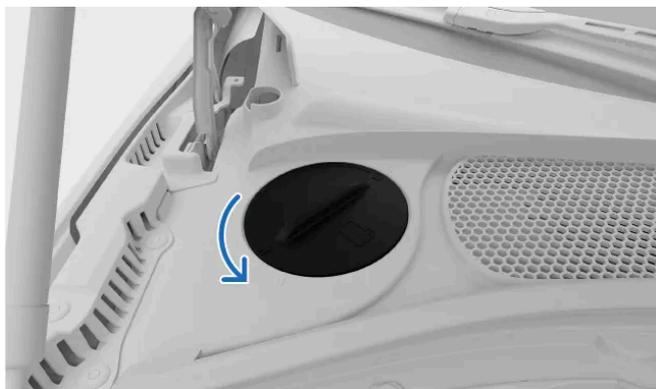
Abra a escotilha do painel no canto superior esquerdo do compartimento do motor para acessar o recipiente do líquido de arrefecimento.
