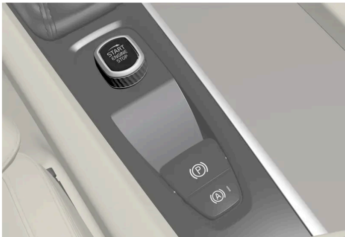
Botão de partida no console de túnel.
