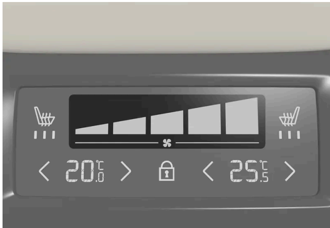
Controle do ventilador no painel de climatização traseiro no console de túnel.
