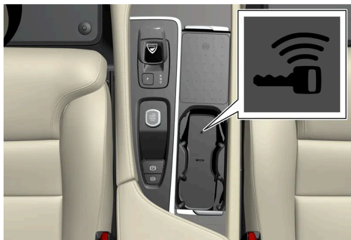
Localização do leitor no console de túnel.
