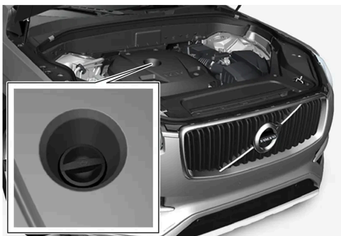
Tubo de enchimento [1] , [2]
