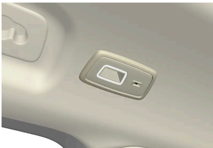
Em veículos com o teto panorâmico*, as duas unidades da lâmpadas estão localizadas em cada lado do teto. [2]
