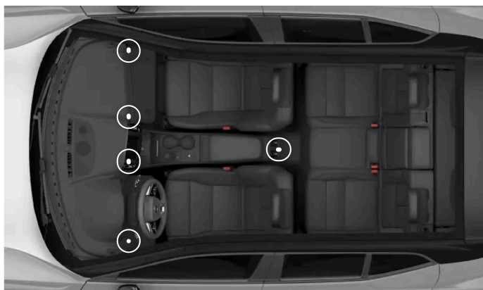
Emplacements des bouches d'air réglables
